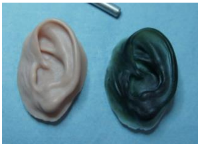
Figure 47 : Modèle en résine d'une prothèse auriculaire imprimé en 3D puis dupliqué en cire (117)
