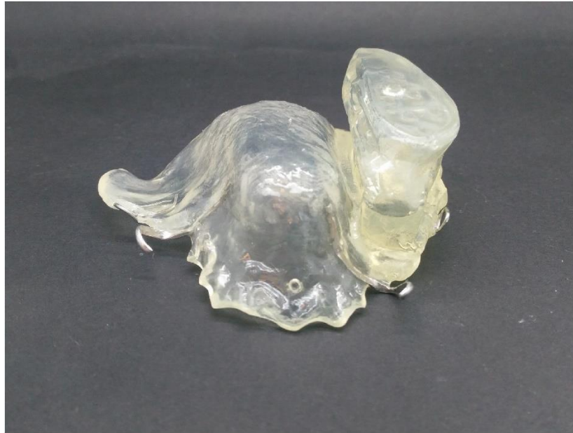
Figure 30 : Obturateur immédiat imprimé en 3D par stéréolithographie (105).
