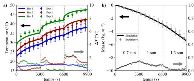
Figure 5 – Températures et masse d'eau expérimentales et simulées sur les trois périodes de validation (0.7, 1 et 1,3 sun)
