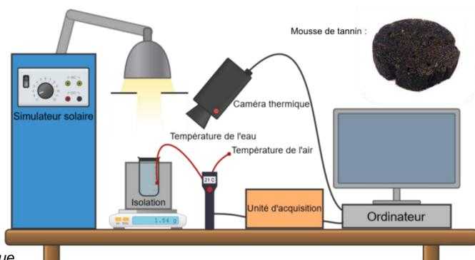
Figure 3 – Montage expérimental
