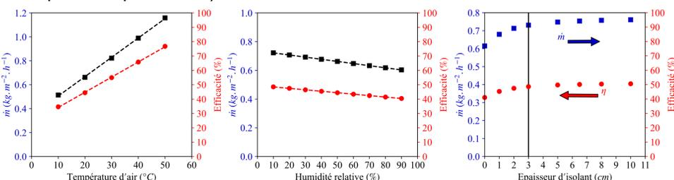
Figure 6 – Flux d'évaporation et efficacité en fonction de la température de l'air, de l'humidité de l'air et de l'épaisseur d'isolant autour du béccher
