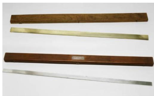
Figure 15 : Mètre étalon en platine de l'armoire de fer des Archives nationales.
