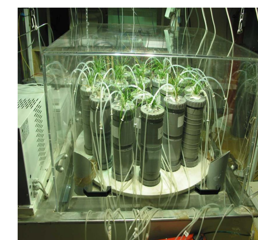
Figure 2 : Dispositif de marquage des plantes.
