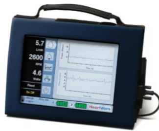
Figure 12 : Moniteur de système du dispositif HEARTWARE HVAD
