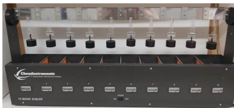
Figure 18 : Test d'adhésion en cisaillement sur des dispositifs transdermiques de type matriciel
