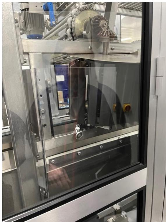
*Figure 19: Visualisation des valves poches, installation d'un carter de protection transparent*
