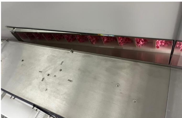
*Figure 14: Visualisation des diffuseurs, installation d'un miroir*
