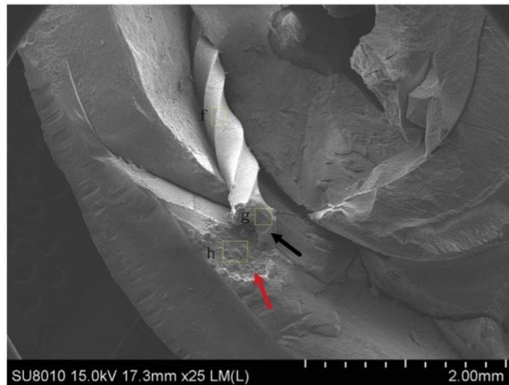
Figure 42 : photographie en stéréomicroscopie d'un Pro Taper® Next X2 fracturé dans un canal après 5 tirs laser : une fusion de la dentine est présentée par la flèche noire et une zone de cratérisation par la flèche rouge (source : Lu Zhang et coll., 2021)
