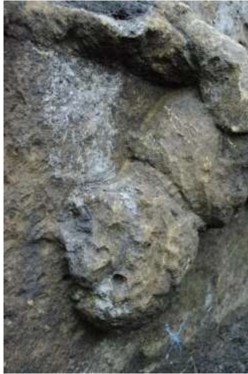
Figure 13 : Dépôt cristallin observé sur les blocs du sondage n° 1 (cliché : J. Trapp)
