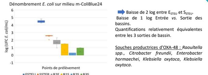
➔ Baisse de 2 log entre ESTEU et SSTEU. Baisse de 1 log Entrée vs. Sortie des bassins. Quantifications relativement équivalentes entre les 3 sorties de bassin.
