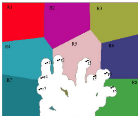
FIGURE 2.5 – Segmentation a priori de l'environnement avec l'algorithme K-means , K étant égal au nombre de robots. Une zone à explorer est ensuite affectée à chaque robot. (Puig et al., 2011)
