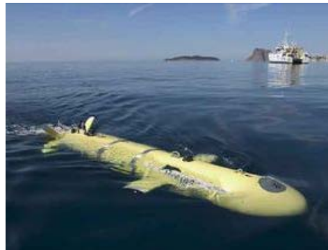
(d) Véhicule sous-marin autonome AS-TER de l'IFREMER pouvant atteindre 3000 mètres de profondeur flotte.ifremer.fr
