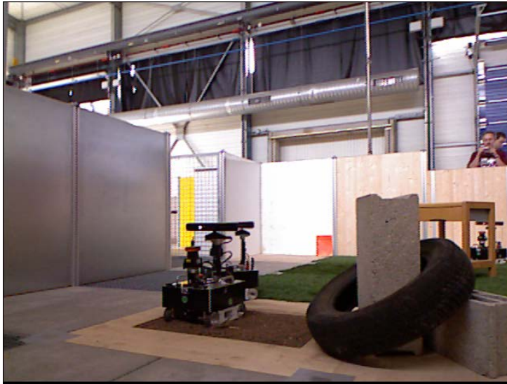
FIGURE 9.4 – Image prise par la Kinect lors de la finale du défi Carotte 2012, robot enlisé dans un bac de terre
