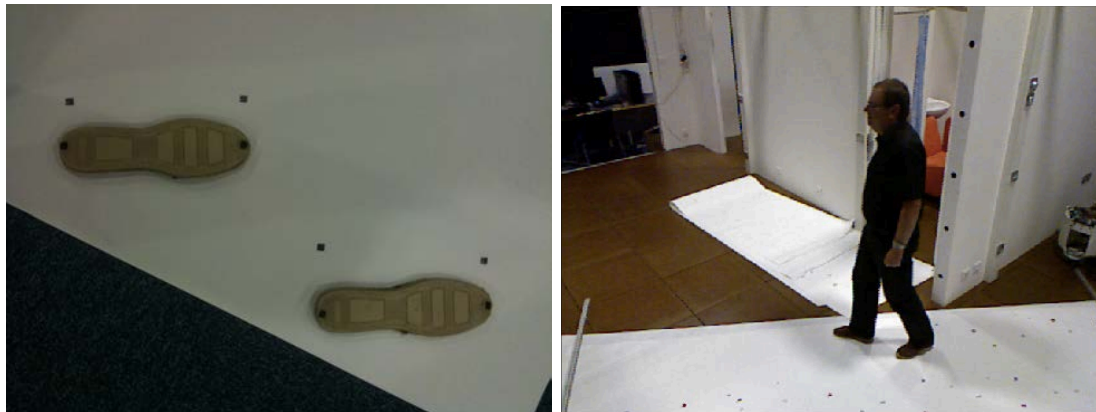
(a) Tampons imbibés d'encre sous les chaussures. (b) Un sujet marche sur le papier et le marque.
