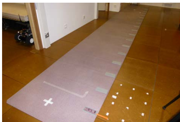
FIGURE 1.4 – Le tapis actimétrique de la marque GaitRite.
