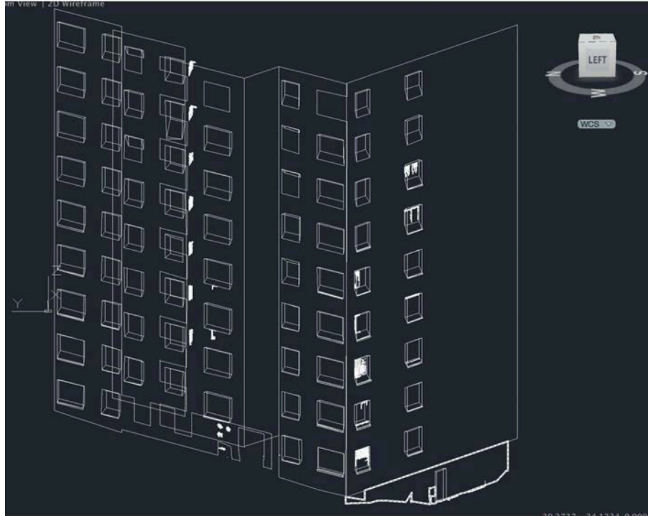
FIGURE 4.22 – Modèle filaire exporté sous format DXF (visualisation sur logiciel Autocad)
