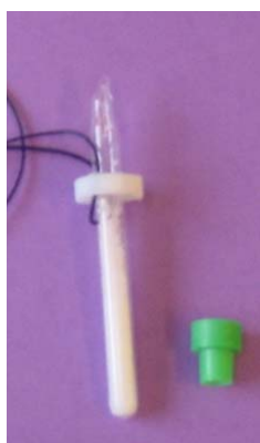
Figure 70 : Exemple de conditionnement des composés azotés inertes : ampoule en verre de 5mm de diamètre remplie sur une hauteur de 3 cm (environ 0.5g de poudre)
