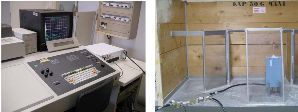
**Figure 46** : A gauche : console d'un spectromètre RMN (AC200) reconverti pour des expériences de RQN et à droite préamplificateur et sonde derrière un écran en plexiglas
