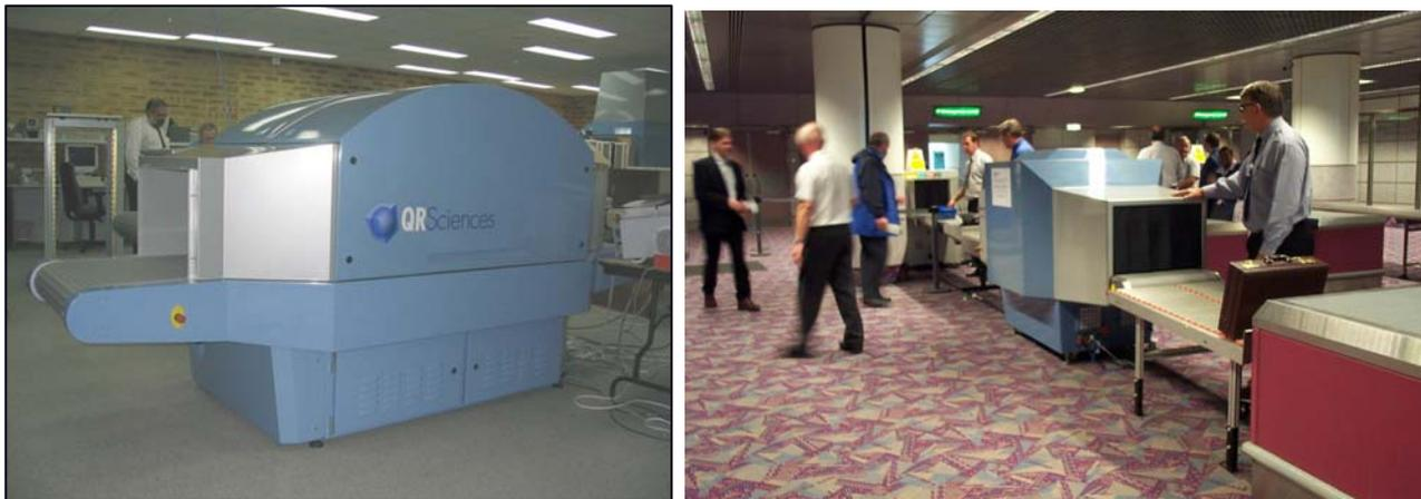
**Figure 10 :** Photographies de l'appareil de RQN T-3-03 qui n'utilise que la RQN comme méthode de détection.
