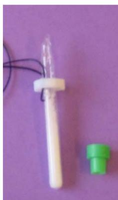
**Figure 70** : Exemple de conditionnement des composés azotés inertes : ampoule en verre de 5mm de diamètre remplie sur une hauteur de 3 cm (environ 0.5g de poudre)
