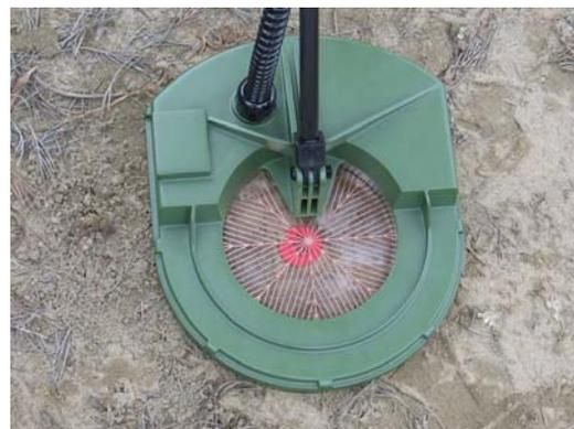
**Figure 23 :** Prototype d'un détecteur de mines antipersonnel
