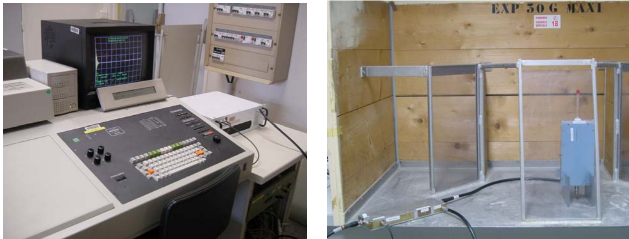
Figure 46 : A gauche : console d'un spectromètre RMN (AC200) reconverti pour des expériences de RQN et à droite préamplificateur et sonde derrière un écran en plexiglas
