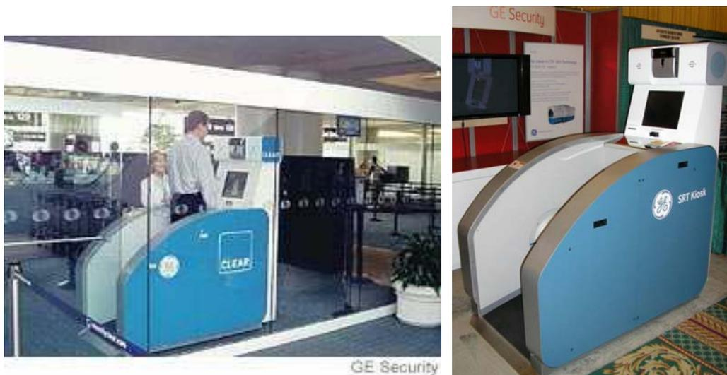
**Figure 26 :** Photographies du détecteur RQN, scanner de chaussures, développé par General Electrics
