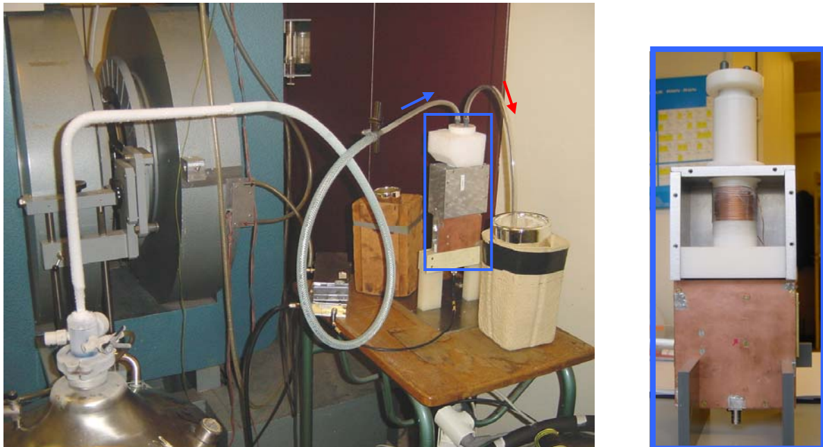
Figure 66 : Dispositif permettant de faire des expériences RQN à très basse température reposant sur une sonde (à droite) spécialement pour ce type de manipulations
