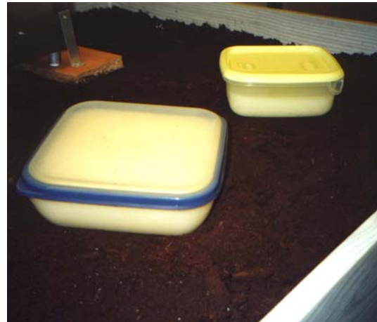
Figure 22 : Détection à distance grâce à une sonde de RQN d'une mine antipersonnel simulée en enterrant une boîte en plastique contenant du RDX.
