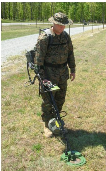
Figure 23 : Prototype d'un détecteur de mines antipersonnel La sonde (à droite) est composés d'un détecteur de métaux couplé à un détecteur RQN
