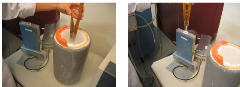
Figure 67 : Augmentation de la sensibilité grâce à un saut de température l'échantillon est plongé quelques secondes dans un Dewar d'azote liquide (à gauche) puis il est placé immédiatement dans la sonde (à droite)
