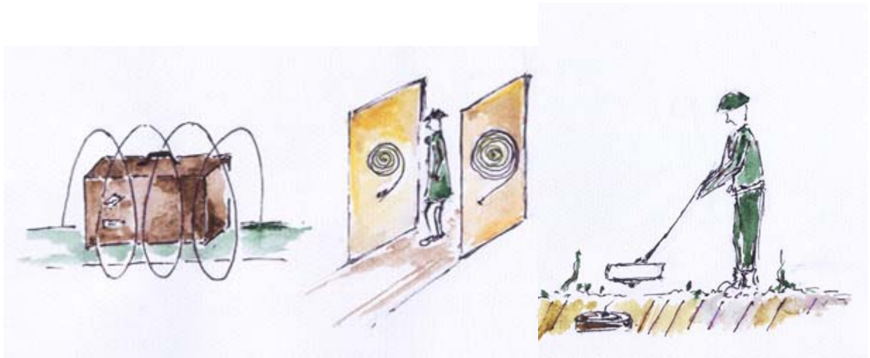
Figure 25 : Utilisations possibles de la RQN pour la détection d'explosifs dans les bagages, sur les voyageurs ou dans le sol.
