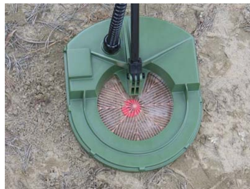
Figure 23 : Prototype d'un détecteur de mines antipersonnel La sonde (à droite) est composés d'un détecteur de métaux couplé à un détecteur RQN
