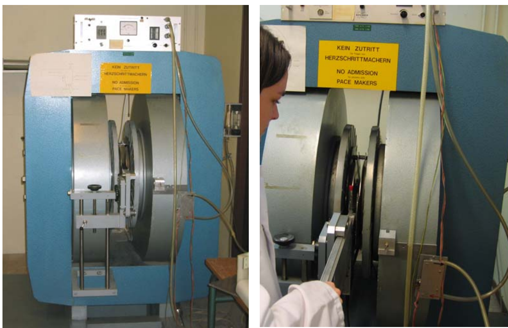
Figure 47 : Photographies d'un électro-aimant à champ variable ( \approx 0 à 2.1T) les sondes RMN-RQN sont placées dans l'aimant grâce à un bras de mesure
