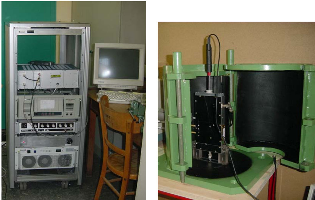
Figure 45 : Spectromètre RQN par impulsion (Prototype I) installé à l'ISL avec à droite la console et à gauche la sonde contenant l'échantillon de RDX, placée dans un caisson de protection
