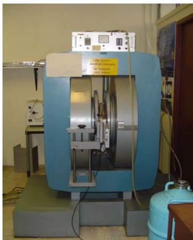
Figure 4 : Electro-aimant à champ variable (0 à 2.1T soit 2100 G)
