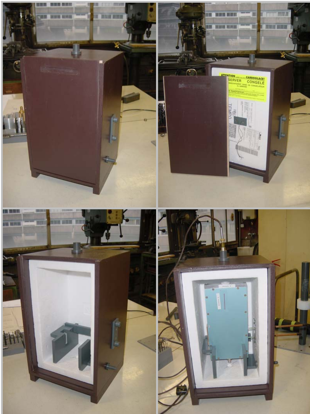
Figure 63 : Enceinte conçue en bois et en polystyrène utilisée pour minimiser les variations de température de l'échantillon
