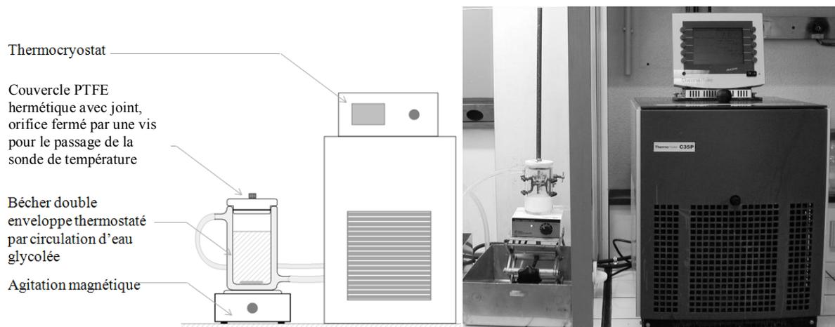
Figure 2-7 : Dispositif de mise à l'équilibre thermodynamique utilisé pour la méthode analytique
