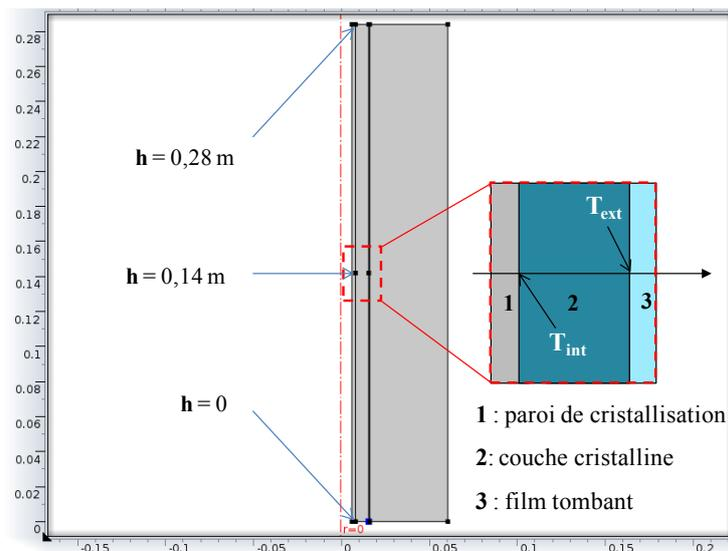
Figure 5-9 : Positionnement des trois hauteurs de suivi du gradient de température dans la couche cristalline avec  $h / m$  la hauteur du tube,  $T_{int} / ^\circ C$  la température à l'interface liquide/cristaux et  $T_{ext} / ^\circ C$  la température de la paroi de cristallisation
