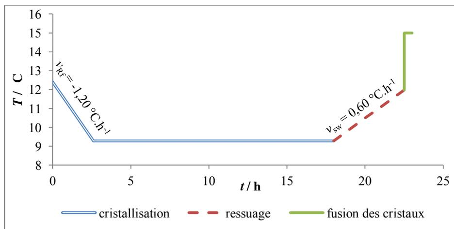
Figure 3-4 : Exemple d'un profil de température utilisé lors d'un cycle de purification : variation de la température  $T / ^\circ\text{C}$  au cours du temps  $t / \text{h}$  avec une vitesse de refroidissement  $v_{Rf}$  fixée à  $-1,20 \text{ } ^\circ\text{C}\cdot\text{h}^{-1}$  et une vitesse de ressuage  $v_{sw}$  de  $+0,60 \text{ } ^\circ\text{C}\cdot\text{h}^{-1}$
