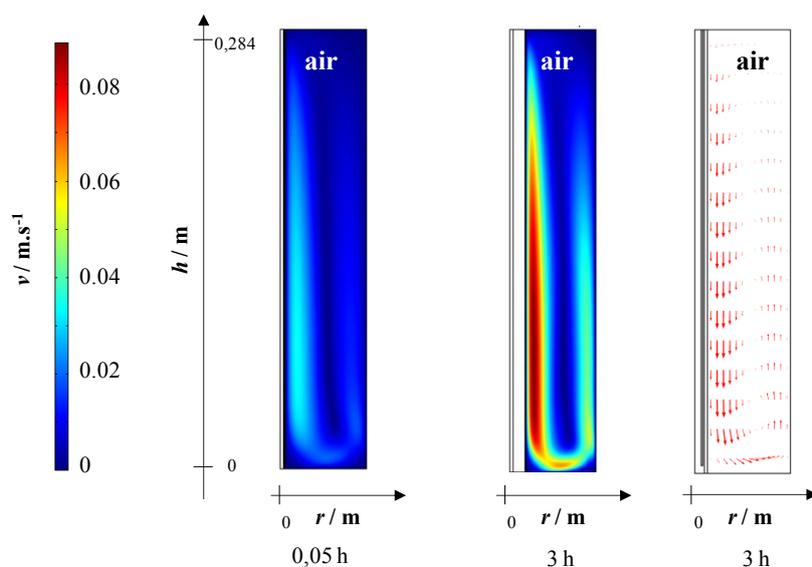
Figure 5-8 : Représentation des profils de vitesse d'écoulement de l'air  $v / \text{m.s}^{-1}$  contenu dans le réservoir de cristallisation avec  $h / \text{m}$  la hauteur du tube et  $r / \text{m}$  distance à l'axe central du tube de cristallisation – gauche : au début de la cristallisation ; milieu : à la fin de la cristallisation ; droite : description des mouvements convectifs de l'air
