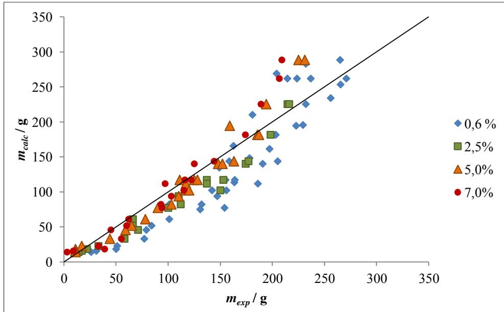
Figure 3-25 : Représentation graphique des masses expérimentales  $m_{exp} / g$  par rapport aux masses calculées par le modèle,  $m_{calc} / g$ . Les différentes séries de points correspondent à des proportions différentes en AP.
