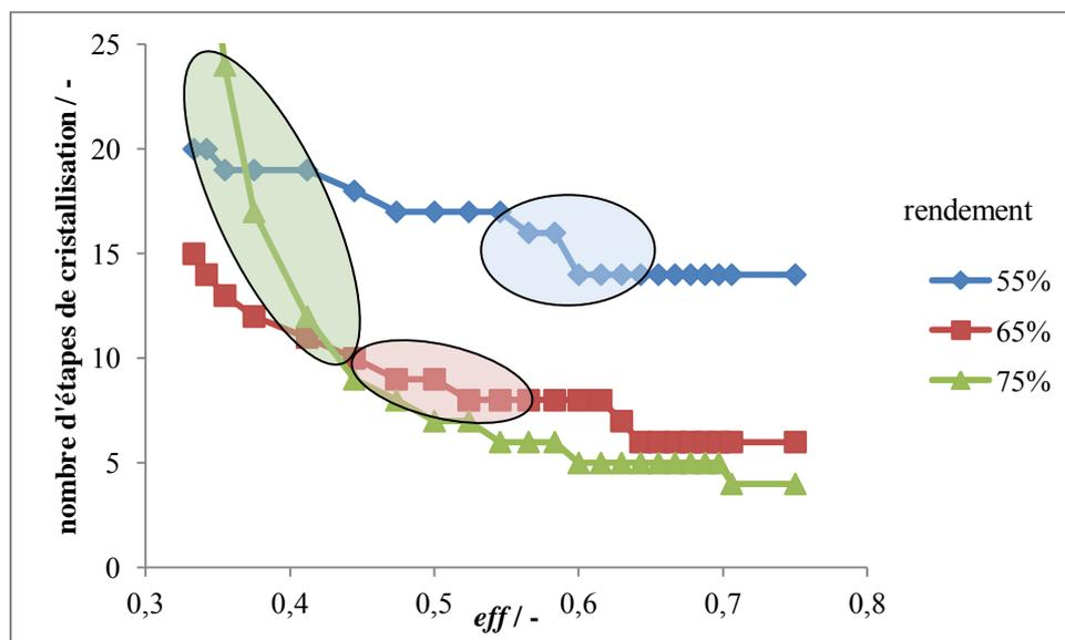
Figure 5-28 : Délimitation des zones déterminées expérimentalement au sein desquelles l'AA est séparé de l'AP. Nombre d'étapes de cristallisation en fonction de l'efficacité  $eff$  / - et du rendement  $\eta$  / %
