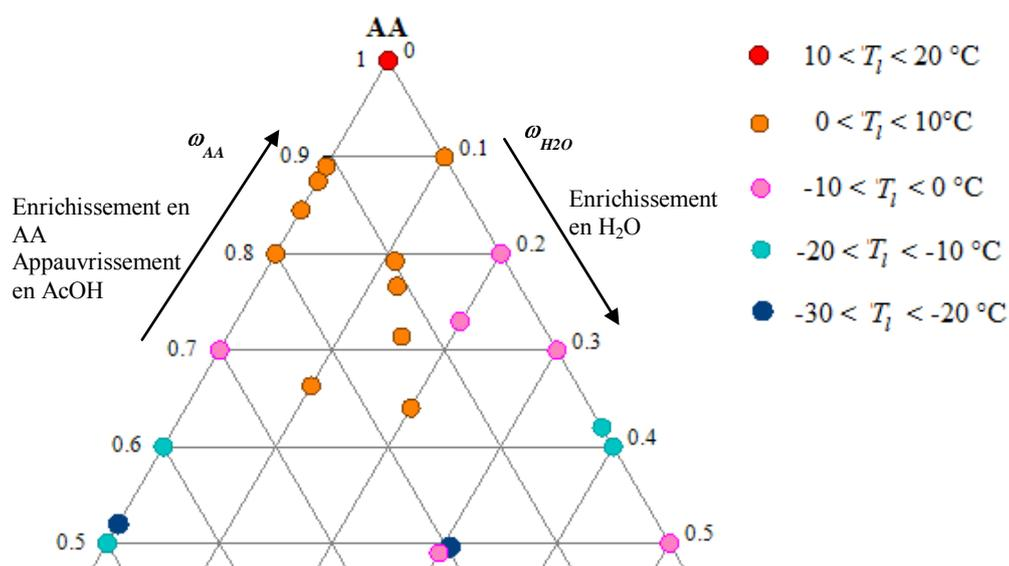
Figure 4-24 : Equilibres liquide-solide AA + H<sub>2</sub>O + AcOH pour des fractions massiques d'AA supérieures ou égales à 0,50
