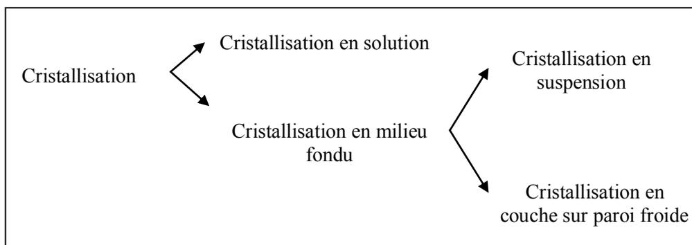
Figure 1-16 : Représentation partielle des procédés de cristallisation
