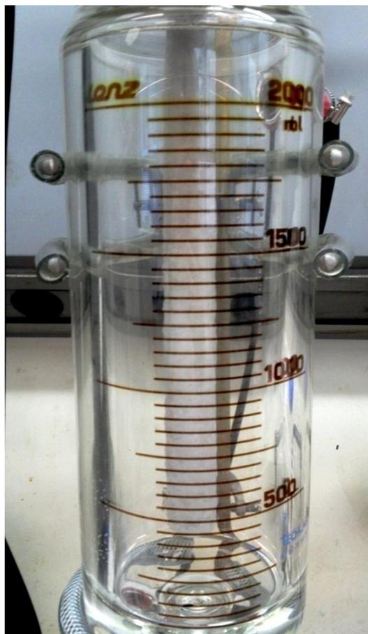
Figure 4-14 : couche cristalline produite sur tube micro-rainuré.
