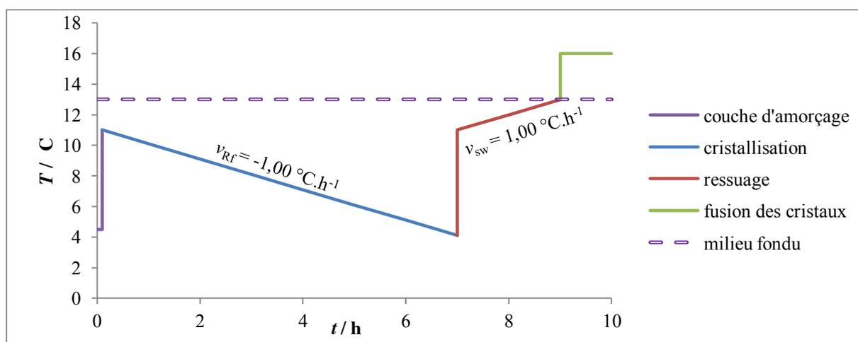
Figure 3-13 : Evolution de la température  $T / ^\circ\text{C}$  du tube de cristallisation (trait plein) et de la double enveloppe thermostatant le milieu fondu (trait en pointillés) en fonction du temps  $t / \text{h}$  lors d'un cycle de purification
