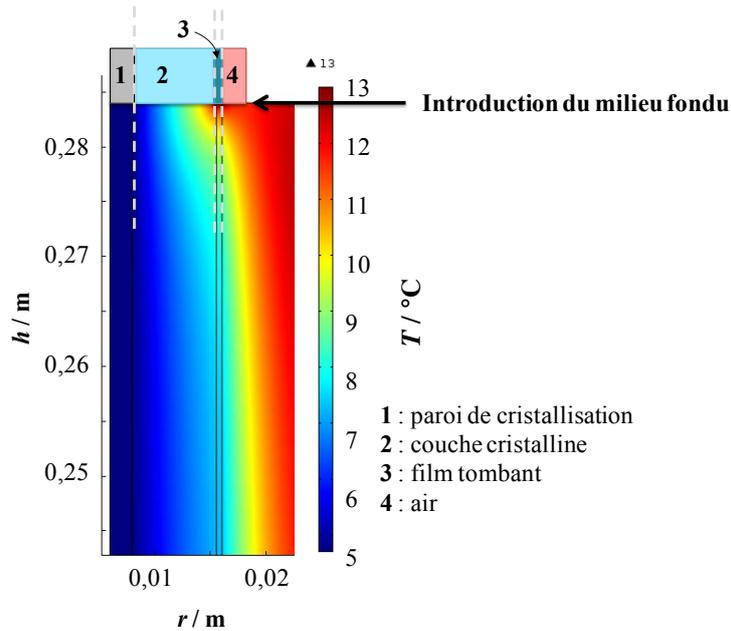
Figure 5-6 : Représentation des gradients de température  $T / ^\circ\text{C}$  – zoom sur les 4 premiers centimètres à partir du point d'injection du milieu fondu – hauteur du tube  $h / \text{m}$  ; distance à l'axe central du tube de cristallisation  $r / \text{m}$
