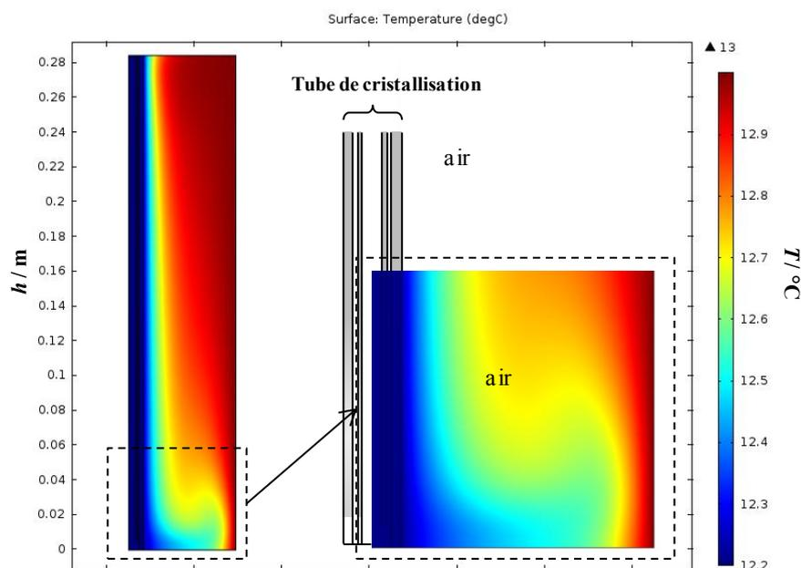
Figure 5-2 : Profil de température  $T / ^\circ\text{C}$  au sein du dispositif en début de cristallisation avec  $h / \text{m}$  la hauteur du tube
