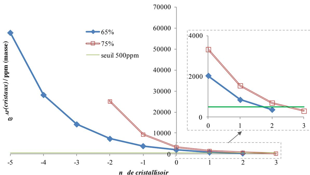
Figure 5-26 : Impact du taux de cristallisation sur la proportion en AP (ppm masse)  $\omega_{AP}(cristaux) / \text{ppm (masse)}$  dans les cristaux à la sortie de chaque cristalliseur avec l'alimentation au cristalliseur n°0 - calculs établis pour purifier un bio-AA brut contenant 6000 ppm d'AP avec une efficacité de 0,57
