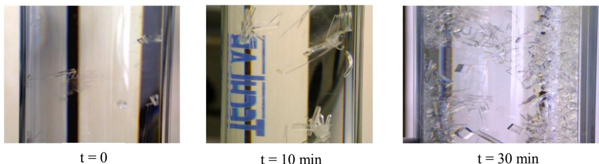
Figure 2-20 : Observation de la formation des cristaux d'un mélange AA + AP (9 080 ppm mol d'AP) à 12,0 °C
