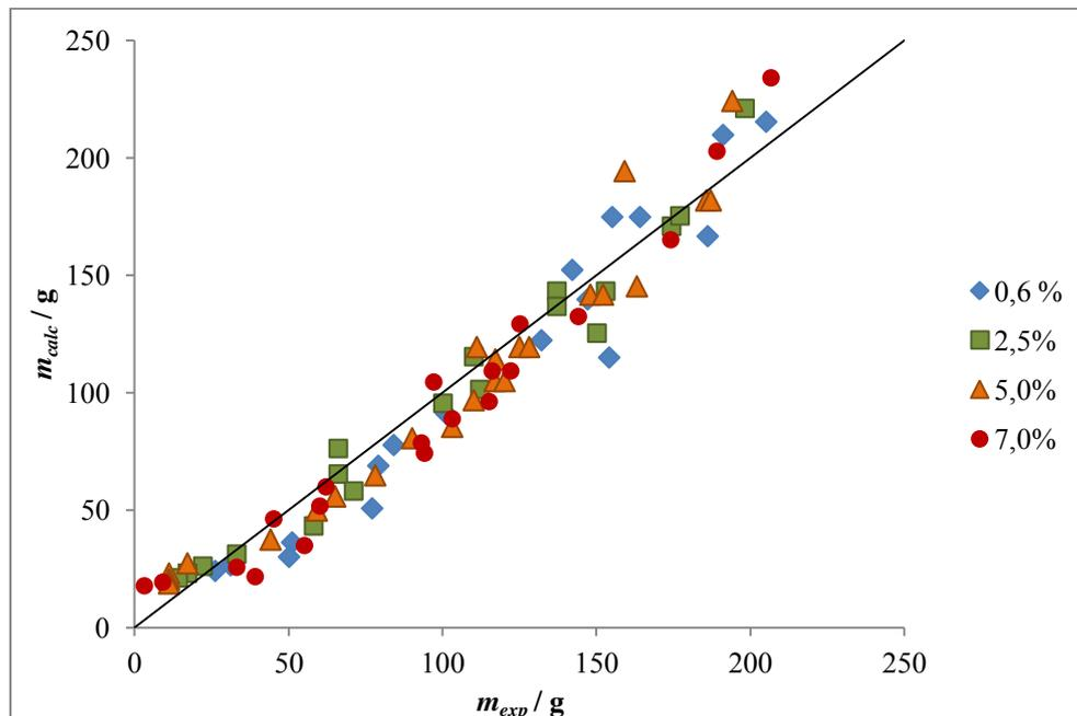
Figure 3-27 : Comparaison des masses expérimentales  $m_{exp} / g$  et calculées  $m_{calc} / g$  à partir du second modèle, dans lequel le coefficient de transfert de chaleur varie avec la proportion d'AP dans la couche cristalline
