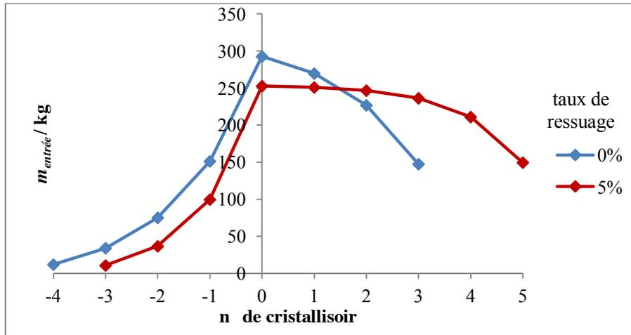
Figure 5-29 : Masse à l'entrée  $m_{entrée} / \text{kg}$  de chaque cristallisoir en fonction du taux de cristallisation avec l'alimentation au cristallisoir n°0 – calculs établis pour purifier 100 kg de bio-AA brut contenant 6000 ppm d'AP avec une efficacité de 0,50
