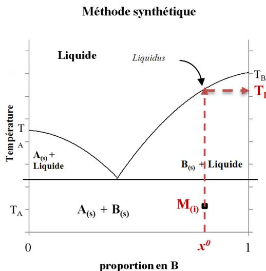
Figure 2-2 : Représentation graphique du principe de la méthode synthétique avec  $x^0$  / - la proportion initiale du composé B ;  $T_l / \text{K}$  la température du liquidus ;  $T_j / \text{K}$  la température de fusion du composé  $j$  (A ou B)
