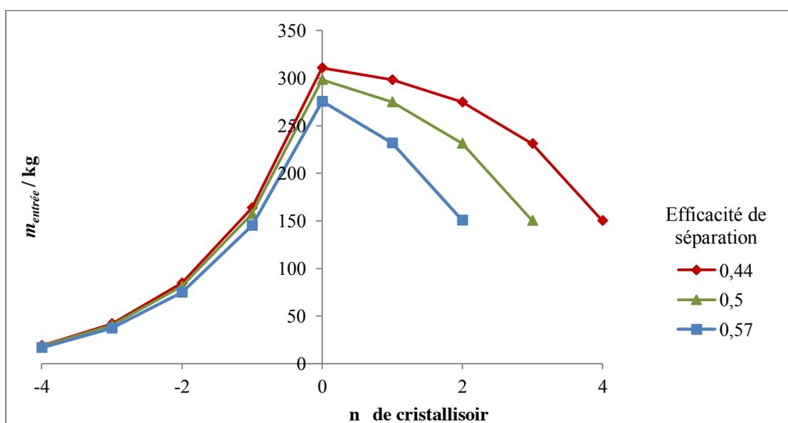
Figure 5-24 : Masse à l'entrée  $m_{entrée}$  / kg de chaque cristalliseur en fonction de l'efficacité de séparation avec l'alimentation au cristalliseur n°0 – calculs établis pour purifier 100 kg de bio-AA brut contenant 6 000 ppm d'AP avec un taux de cristallisation de 65 % et un taux de ressuage nul.
