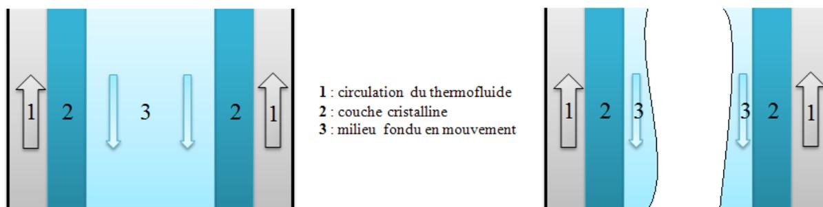
Figure 1-21 : Description de la cristallisation en couche sur paroi froide en mode dynamique : en tube plein (à gauche) et en film tombant (à droite)
