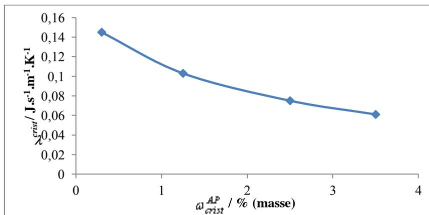
Figure 3-26 : Evolution du coefficient d'échange thermique  $\lambda_{crist} / \text{J.s}^{-1}\text{K}^{-1} \cdot \text{m}^{-1}$  en fonction de la quantité d'AP  $\omega_{crist}^{AP} / \% \text{ (masse)}$  présente dans la couche cristalline
