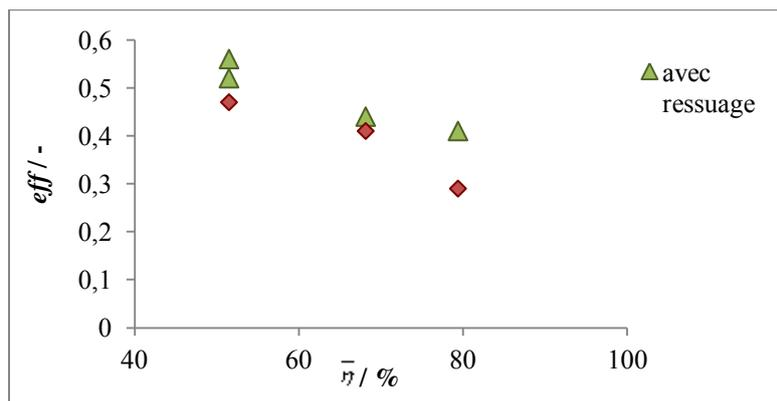
Figure 3-20 : Impact du ressuage sur l'efficacité du procédé  $eff / -$  pour différents rendements moyens  $\bar{\eta} / \%$  – le taux de ressuage est compris entre 1,9 % et 3,2 % de la masse cristalline
