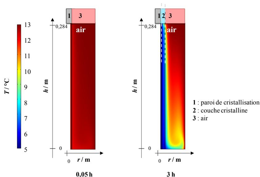
Figure 5-5 : Représentation des gradients de température  $T / ^\circ\text{C}$  sur l'ensemble de la hauteur du dispositif avec  $h / \text{m}$  la hauteur du tube et  $r / \text{m}$  distance à l'axe central du tube de cristallisation – **gauche** : début de la cristallisation ; **droite** : fin de l'étape de cristallisation
