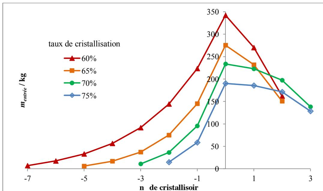
Figure 5-25 : Masse à l'entrée  $m_{entrée}$  / kg de chaque cristallisoir en fonction du taux de cristallisation avec l'alimentation au cristallisoir n°0 – calculs établis pour purifier 100 kg de bio-AA brut contenant 6000 ppm d'AP avec une efficacité de 0,57
