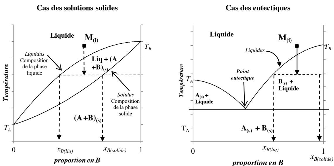
Figure 2-1 : Représentations graphiques de diagrammes de phases liquide-solide d'un binaire formant une solution solide (gauche) et d'un binaire à eutectique (droite) avec  $x_B$  / - (mol) la fraction massique du composé B et  $T_j / K$  la température de fusion du composé  $j$  pur (A ou B)
