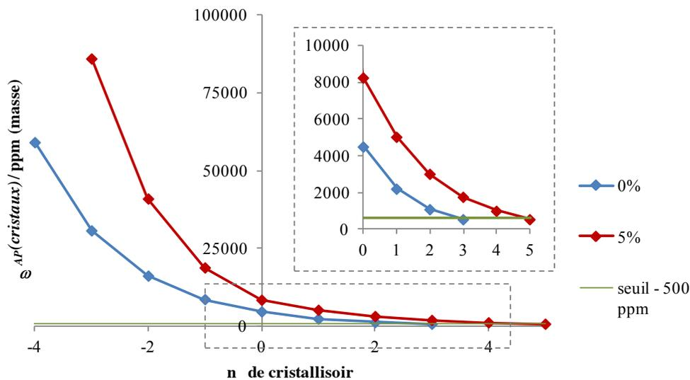
Figure 5-29 : Variation de la fraction massique en AP  $\omega_{AP}(\text{cristaux}) / \text{ppm}$  dans les cristaux à la sortie de chaque cristallisoir avec l'alimentation au cristallisoir n°0 - calculs établis pour purifier un bio-AA brut contenant 6000 ppm d'AP avec une efficacité de 0,57
