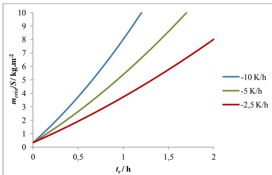
Figure 3-28: Simulation de l'évolution de la masse de cristaux par unité de surface  $m_{crist}/S / kg.m^{-2}$  en fonction du temps  $t_c / h$  et de la vitesse de refroidissement du tube de cristallisation
