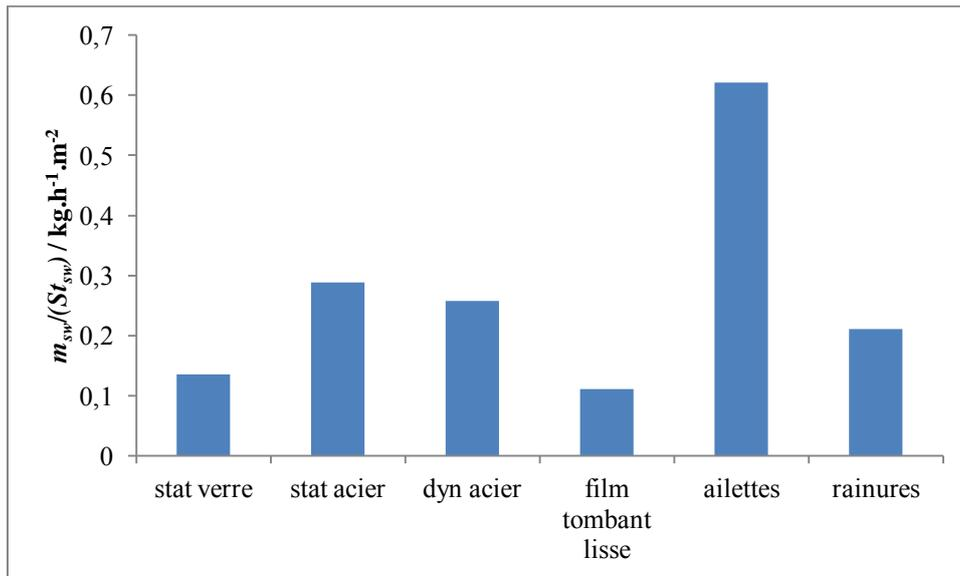
Figure 4-18 : Production de liquide issu du ressuage par unité de surface, en fonction du type de cristalliseur à une vitesse de réchauffement du tube de  $+ 5 \text{ }^\circ\text{C.h}^{-1}$  –  $m_{sw} / \text{kg}$  la masse de liquide issu du ressuage ;  $t_{sw} / \text{h}$  la durée du ressuage ;  $S / \text{m}^2$  la surface du tube de cristallisation
