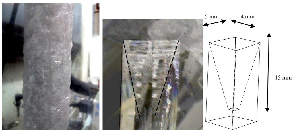
Figure 3-14 : **Gauche** : couche cristalline d'AA obtenue en film tombant (diamètre : 30 mm)
