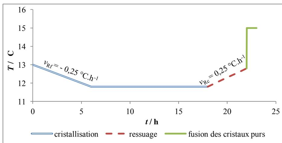
Figure 2-19 : Exemple d'un profil de température utilisé lors d'un cycle de purification : variation de la température  $T / \text{°C}$  au cours du temps  $t / \text{h}$  avec une vitesse de refroidissement  $v_{Rf}$  prise à  $-0,25 \text{ °C.h}^{-1}$  et une vitesse de ressuage  $v_{sw}$  de  $+0,25 \text{ °C.h}^{-1}$
