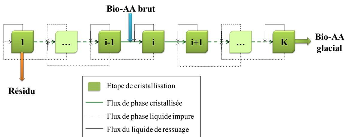
Figure 5-17: Exemple de purification du bio-AA brut par une série de cristallisoirs fermés
