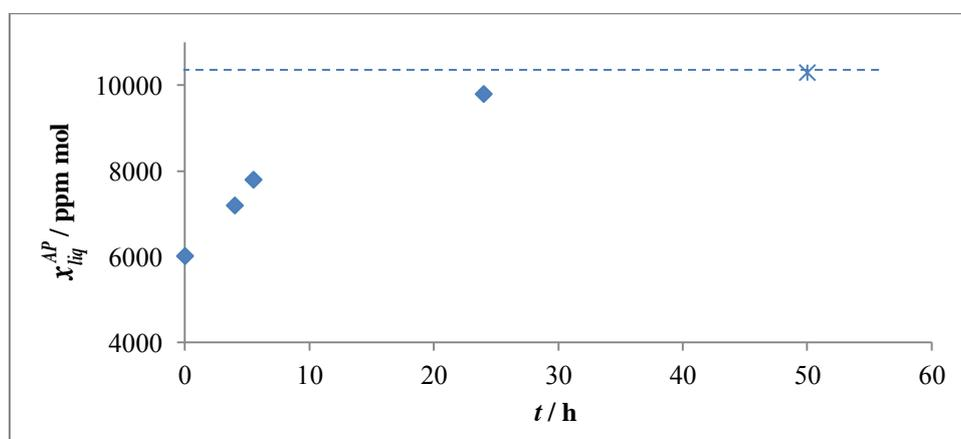
Figure 2-28 : Représentation de l'évolution de la fraction molaire d'AP  $x_{liq}^{AP} / \text{ppm mol}$  dans la phase liquide au cours d'une étape de cristallisation en tube calandre en verre. L'asymptote en pointillés et l'étoile représentent la valeur à l'équilibre thermodynamique qui n'a pas été mesurée au cours de cette expérimentation (24 h).
