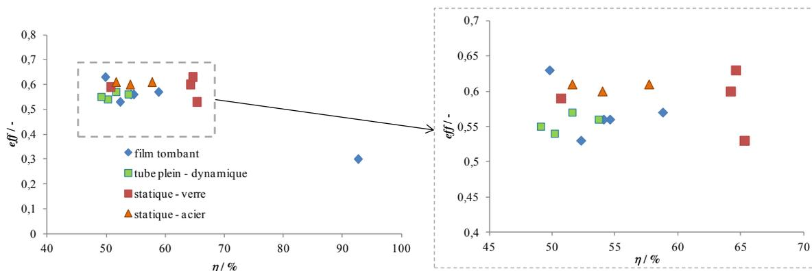
Figure 3-29 : Evolution de l'efficacité  $eff/-$  en fonction du rendement  $\eta/ \%$  et comparaison entre cristallisation en mode statique (verre ■ et acier ▲) et en mode dynamique (tube plein ■ et film tombant ◇) dans des conditions opératoires similaires
