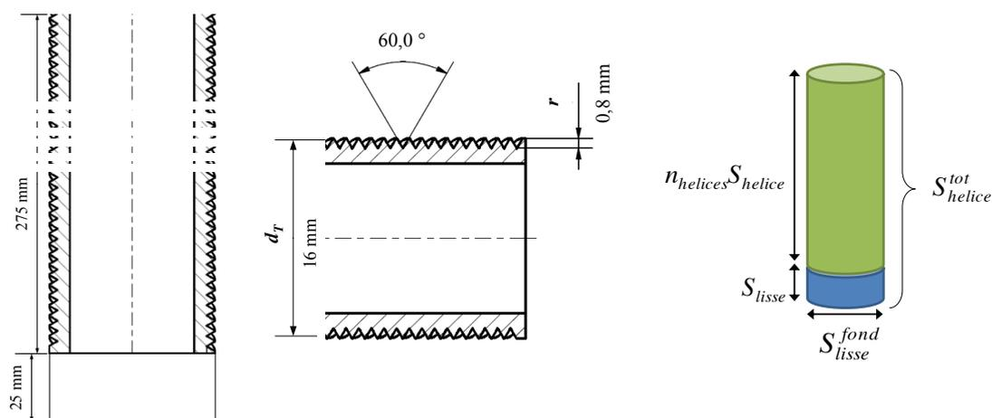
Figure 4-4 : **Droite et centre** : coupe du tube de cristallisation avec des rainures hélicoïdales avec  $r$  / mm la profondeur des rainures ;  $d_T$  / mm le diamètre extérieur du tube de cristallisation
