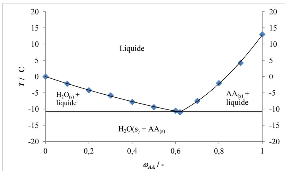
Figure 4-23 : Diagramme de phases liquide-solide H<sub>2</sub>O + AA (Chubarov et al. 1978) avec  $T / ^\circ\text{C}$  la température et  $\omega_{AA} / -$  la fraction massique en AA.
