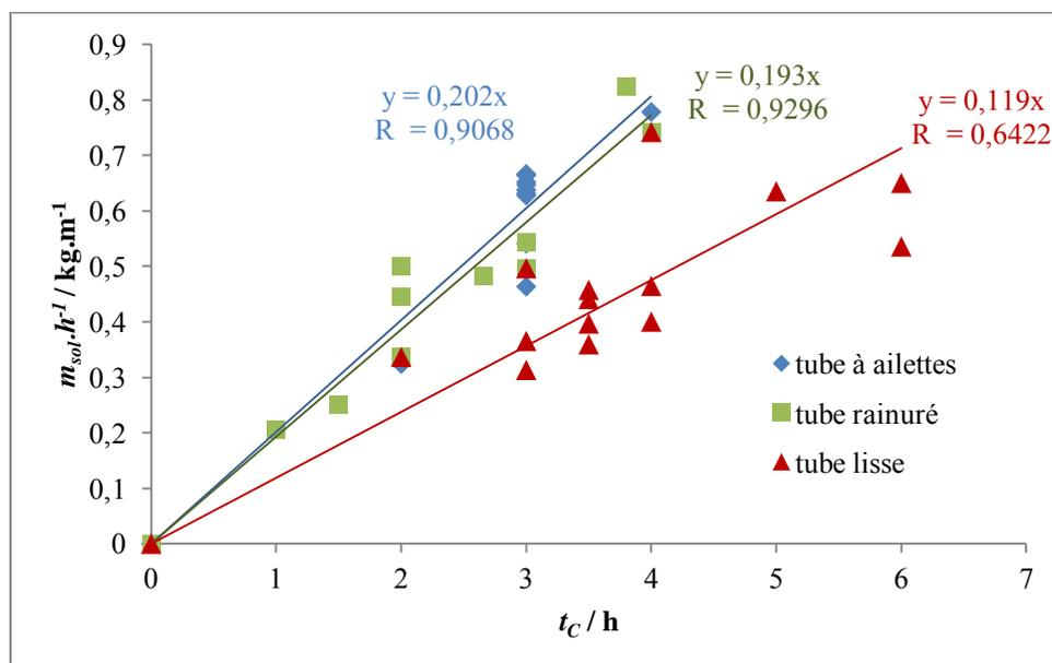
Figure 4-17 : Evolution de la masse cristalline par hauteur de tube  $m_{\text{sol}} \cdot \text{h}^{-1} / \text{kg} \cdot \text{m}^{-1}$  en fonction de la durée de cristallisation  $t_c / \text{h}$  à la vitesse de refroidissement de  $-2,5 \text{ }^\circ\text{C}\cdot\text{h}^{-1}$
