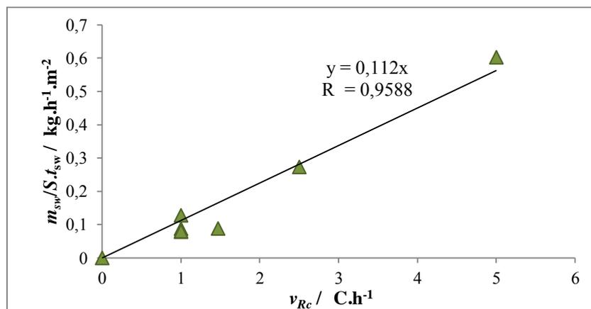
Figure 3-23 : Evolution de la masse de cristaux fondus par unité de surface et de temps  $m_{sw}/S.t_{sw} / \text{kg.m}^{-2} . \text{h}^{-1}$  en fonction de la vitesse de réchauffement de la surface de cristallisation  $v_{Rc} / \text{°C.h}^{-1}$
