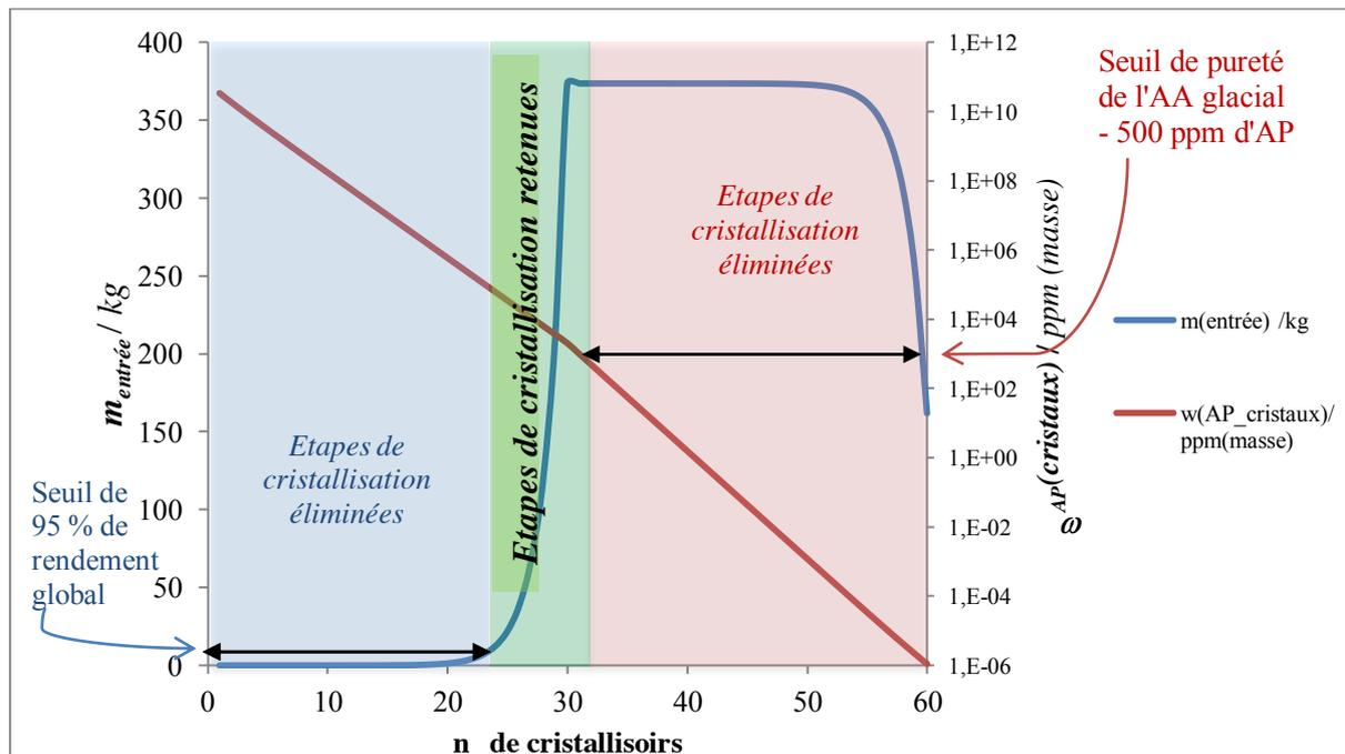
Figure 5-21 : Schématisation du fonctionnement du sous-programme `elimination` à partir d'une simulation de purification de 100 kg d'un AA brut contenant 6000 ppm (masse) d'AP, avec un taux de cristallisation de chaque étape de 65 %, un taux de ressuage de 5 %, une efficacité de purification globale de 0,5 – avec  $m_{\text{entrée}} / \text{kg}$  la masse à l'entrée de chaque cristallisoir ;  $w_{\text{AP(cristaux)}} / \text{ppm (masse)}$  la teneur en AP dans les cristaux
