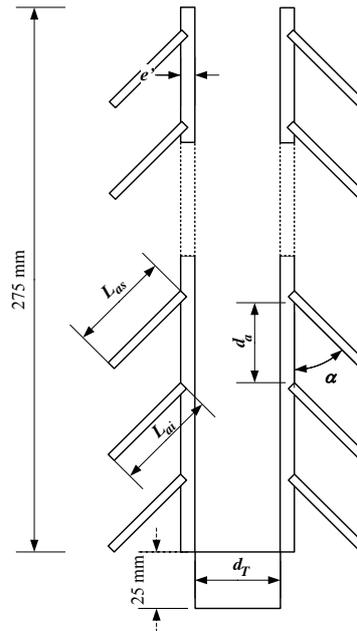
Figure 4-3 : Dimensions caractéristiques du tube de cristallisation avec ailettes avec  $L_{as}$  / **mm** la longueur supérieure de l'ailette ;  $L_{ai}$  / **mm** la longueur inférieure de l'ailette ;  $d_a$  / **mm** la distance entre deux ailettes successives ;  $d_T$  / **mm** le diamètre externe du tube de cristallisation ;  $\alpha$  / ° l'angle d'inclinaison des ailettes ;  $e'$  / **mm** l'épaisseur du support des ailettes.
