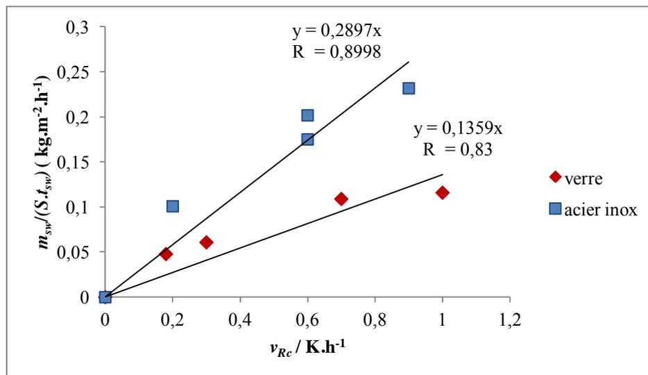
Figure 2-31 : Etude du ressuage et comparaison verre / acier inox - masse de cristaux fondus par unité de surface et de temps  $m_{sw} / S.t_{sw} / kg.m^{-2}.h^{-1}$  en fonction de la vitesse de réchauffement de la surface de cristallisation  $v_{Rc} / ^\circ C.h^{-1}$
