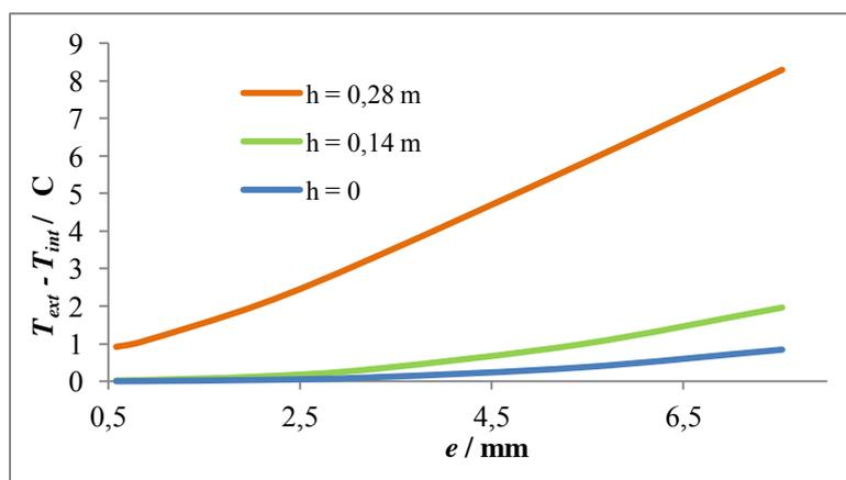
Figure 5-10 : Ecart de température entre les extrémités de la couche cristalline – l'interface film tombant / cristaux :  $T_{ext} / ^\circ C$  et l'interface paroi de cristallisation / cristaux :  $T_{int} / ^\circ C$
