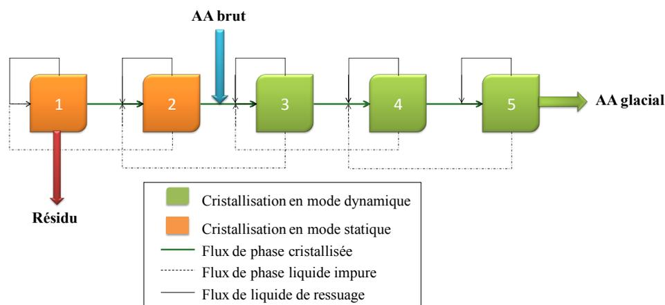
Figure 1-22 : Ensemble du dispositif de purification de l'AA par cristallisation en milieu fondu breveté par Nippon Shokubai (Ueno et al. 2002)
