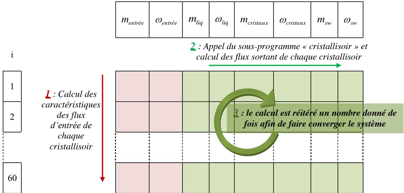
Figure 5-20: Illustration du fonctionnement du sous-programme *iteration* à partir du tableau de composition des différentes fractions issues des cristallisoirs placés en série avec : *m* / la masse, *ω* / la fraction massique en AP, *entrée* / l'alimentation du cristallisoir, *liq* / la phase liquide impure riche en AP, *cristaux* / les cristaux purifiés et *sw* / la phase liquide issue du ressuage
