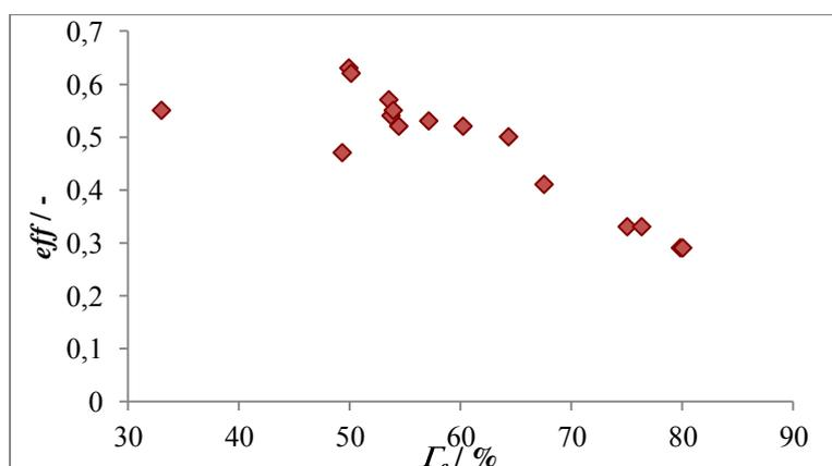
Figure 3-18 : Efficacité  $eff / -$  en fonction du taux de cristallisation  $\Gamma_c / \%$  pour une vitesse de refroidissement de  $-2,5 \text{ }^\circ\text{C.h}^{-1}$
