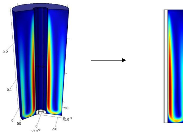
Figure 5-1 : Représentation de la symétrie cylindrique du système et simplification de l'étude
