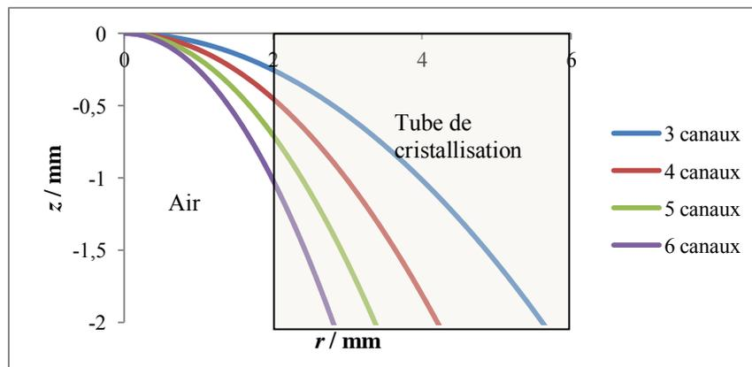
Figure 3-9 : Représentation du jet d'AA à purifier à la sortie d'un canal du distributeur, en fonction du nombre de canaux total -  $z$  / mm la hauteur en sortie d'un canal ;  $r$  / mm la distance à la sortie du canal
