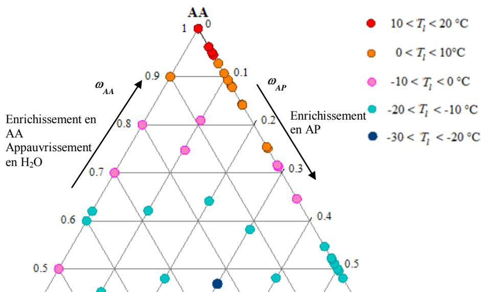
Figure 4-25 : Diagramme de phases ternaire AA + H<sub>2</sub>O + AP pour des fractions massiques d'AA supérieures ou égales à 0,50
