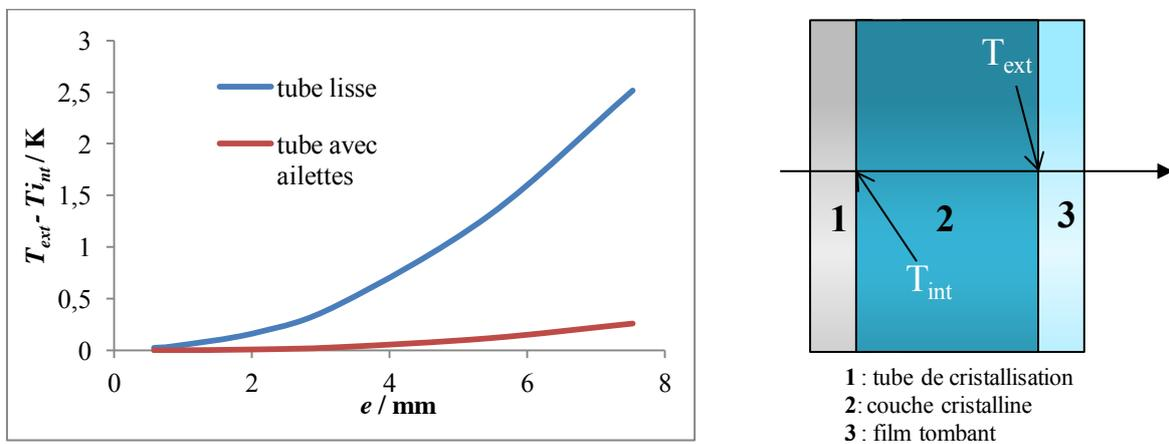
Figure 5-16 : Représentation graphique de l'écart de température entre les extrémités de la couche cristalline - l'interface film tombant / cristaux :  $T_{ext}/^\circ\text{C}$  et l'interface tube / cristaux :  $T_{int}/^\circ\text{C}$
