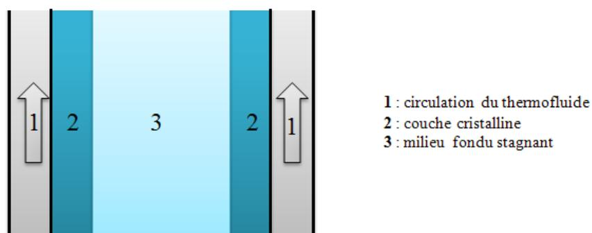
Figure 2-16 : Description de la cristallisation en couche sur paroi froide en mode statique
