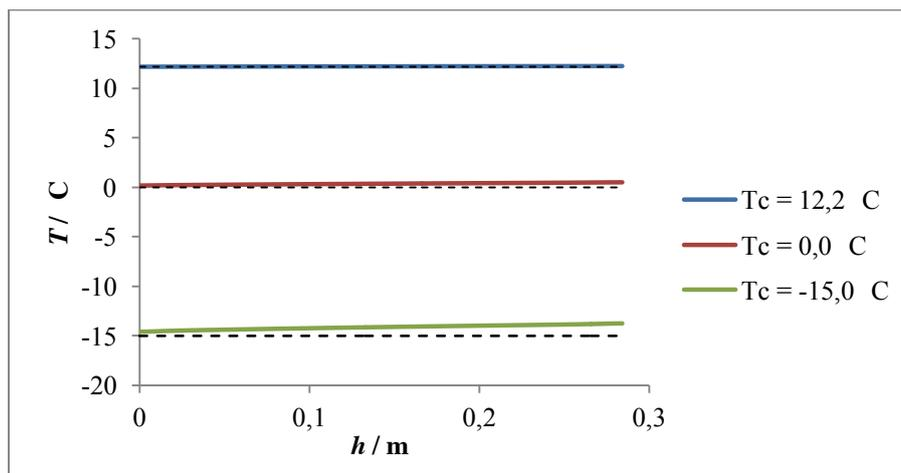
Figure 5-3 : Evolution de la température  $T / ^\circ\text{C}$  le long du tube de cristallisation avec  $h / \text{m}$  la hauteur du tube, pour différentes températures du fluide caloporteur représentées en pointillés : 12,2 °C ; 0,0 °C et -15,0 °C.
