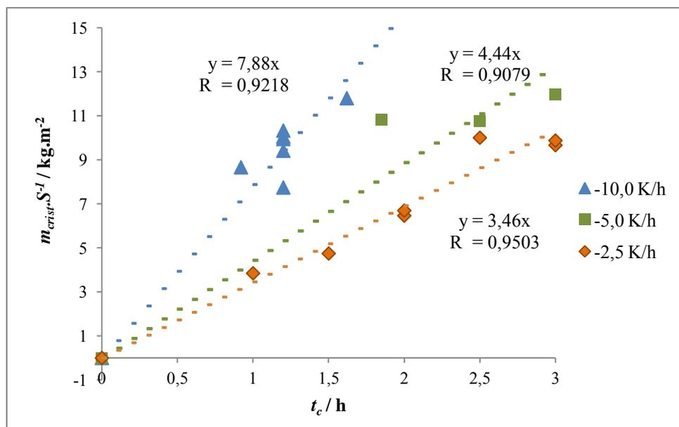
Figure 3-22 : Evolution de la masse cristallisée par unité de surface  $m_{crist} \cdot S^{-1} / \text{kg} \cdot \text{m}^{-2}$  en fonction de la durée de cristallisation  $t_c / \text{h}$  à différentes vitesses de refroidissement :  $\bullet$  -2,5 °C.h<sup>-1</sup> ;  $\blacksquare$  -5,0 °C.h<sup>-1</sup> ;  $\blacktriangle$  -10 °C.h<sup>-1</sup>
