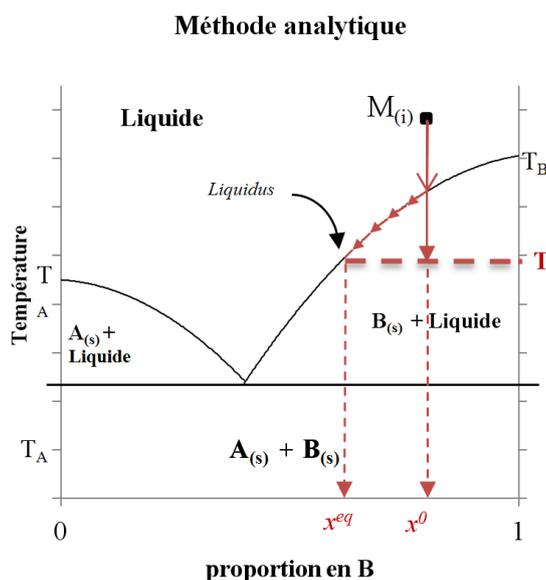
Figure 2-5 : Représentation graphique du principe de la méthode analytique avec  $x^0$  / - la proportion initiale du composé B ;  $x^{eq}$  / - la proportion du composé B à l'équilibre;  $T$  /  $K$  la température ;  $T_j$  /  $K$  la température de fusion du composé  $j$  (A ou B)
