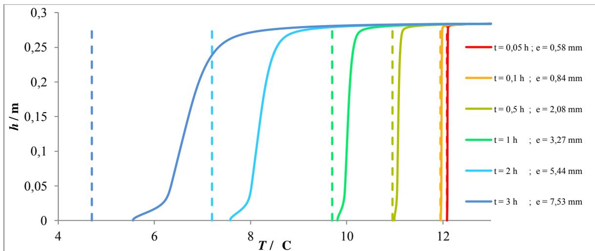
Figure 5-7 : Profils de température  $T / ^\circ\text{C}$  dans le dispositif avec  $h / \text{m}$  la hauteur du tube – trait plein : température à l'interface film tombant / cristaux ; trait en pointillés : température du fluide caloporteur
