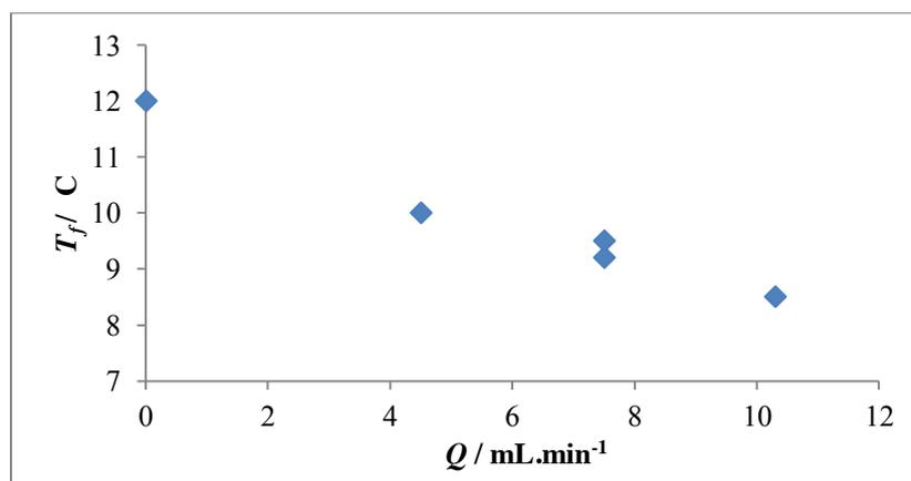
Figure 3-5 : Impact du débit de recirculation  $Q / \text{mL}\cdot\text{min}^{-1}$  du milieu fondu sur la température finale  $T_f / ^{\circ}\text{C}$  de cristallisation, pour de mêmes températures initiales et à vitesses de refroidissement constantes –  $Q = 0$  correspond au mode statique
