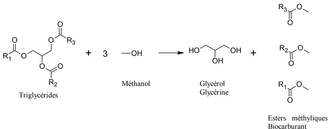
Figure 1-4 : Méthanolyse des triglycérides, constituants des huiles végétales, et formation du glycérol/glycérine
