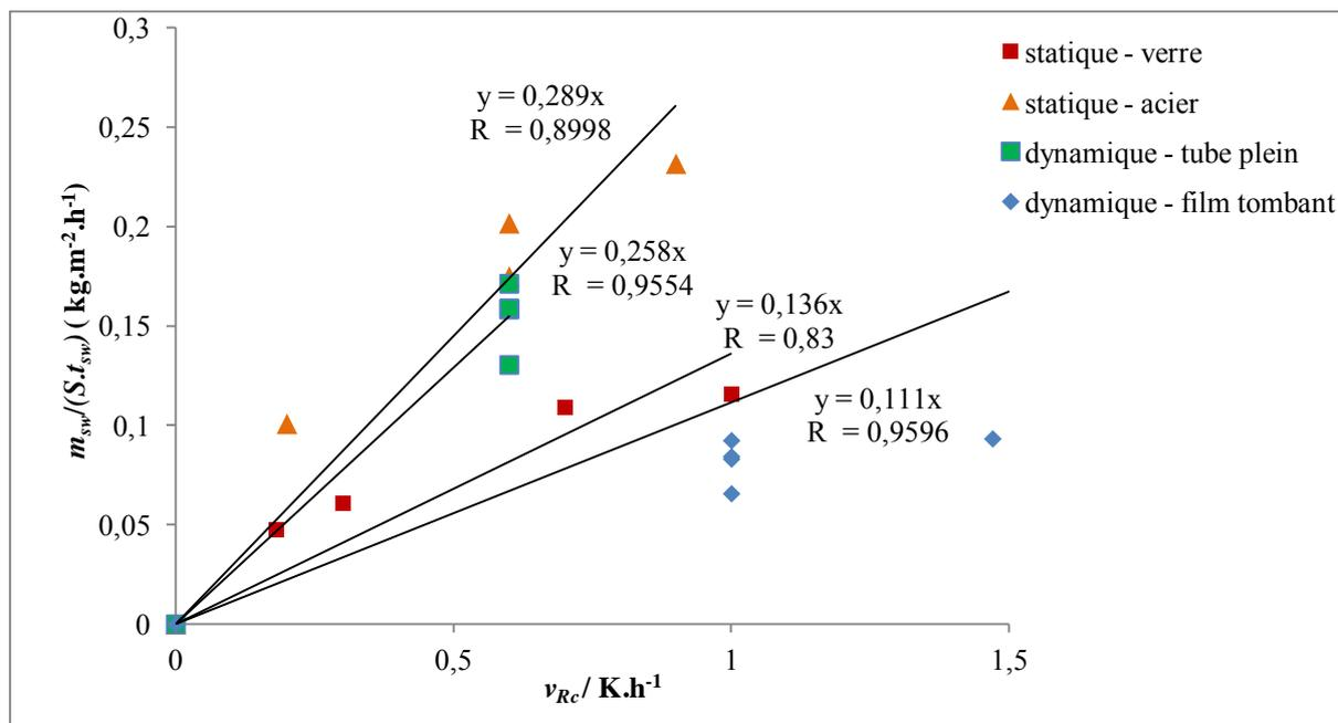
Figure 3-30 : Masse de cristaux fondus par unité de surface et unité de temps  $m_{sw}/t_{sw} \cdot S / \text{kg} \cdot \text{h}^{-1} \cdot \text{m}^{-2}$  en fonction de la vitesse de réchauffement de la surface de cristallisation  $v_{Rc} / \text{°C} \cdot \text{h}^{-1}$  et comparaison entre cristallisation en mode statique (verre ■ et acier ▲) et en mode dynamique (tube plein ■ et film tombant ◇)
