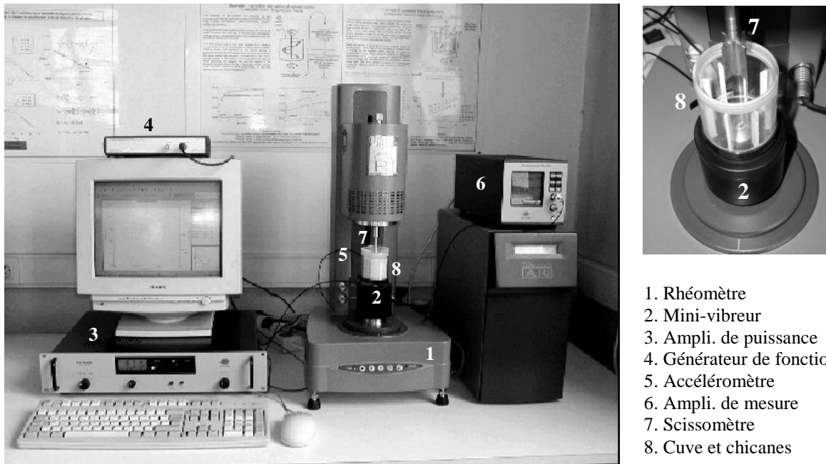
Figure 1.1: Rhéomètre à poudre et cellule de mesure.
