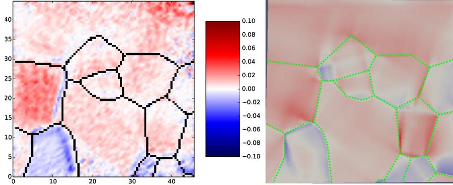
FIGURE 1.10 – Distribution de  $\varepsilon_{xy}$  à  $-1\%$  de déformation macroscopique : mesures DIC (à gauche) et simulation RPMFDM (à droite). Les positions initiales des joints de grains sont indiquées en noir ou en vert.
