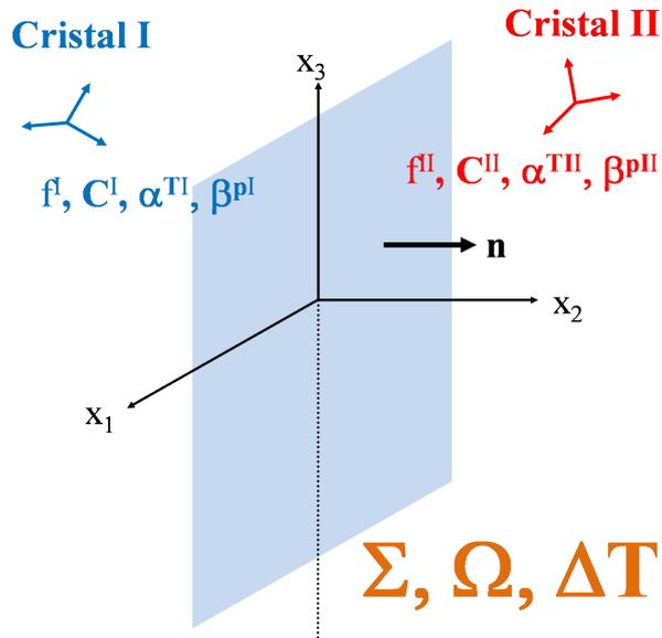
FIGURE 2.1 – Bicristal infini avec interface plane.
