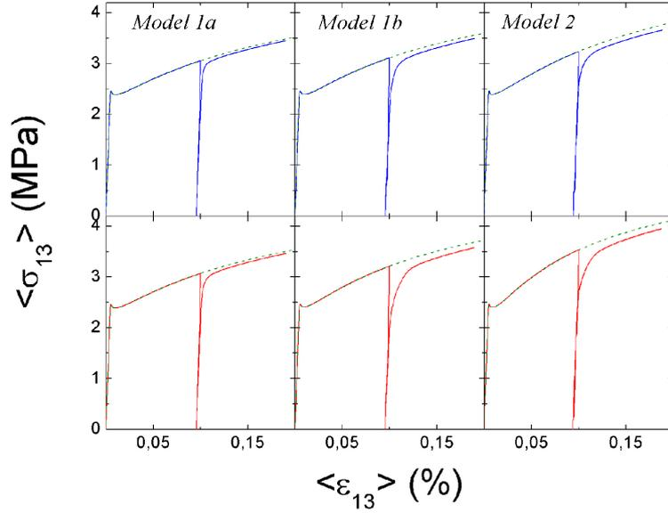
FIGURE 1.4 – Courbes contrainte-déformation obtenues par les 3 modèles pour des particules de fraction volumique 0.8% et de taille  $20 * 20 * 20 \mu\text{m}^3$  (haut) et  $10 * 10 * 10 \mu\text{m}^3$  (bas). Le sens de cisaillement est inversé après 0.1%. Pour faciliter les comparaisons, les courbes inverses sont réfléchies dans le domaine direct.
