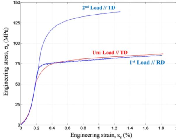
FIGURE 3.7 – Courbes contrainte-déformation obtenues par compression de cubes d’AZ31 selon RD + TD ou uniquement TD.
