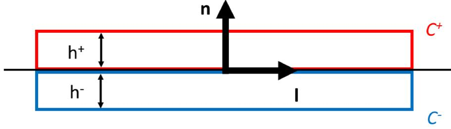
FIGURE 1.1 – Schéma de deux circuits de Burgers  $C^+$  et  $C^-$ , d'épaisseur respective  $h^+$  et  $h^-$ , qui sont adossés à une interface plane de normale  $\underline{n}$  le long de  $\underline{l}$  ( $\underline{l}$  étant un vecteur arbitraire dans le plan de l'interface).
