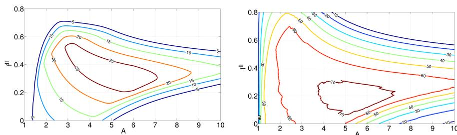
FIGURE 2.12 – Cartes indiquant la proportion des orientations caractérisées, simultanément dans les phases parent et maclée, à la fois par  $R_2 > 1.2$  et une cission résolue maximale sur un plan  $B$  (carte de gauche) ou seulement par une cission résolue maximale sur un plan  $B$  (carte de droite). Seules les orientations initialement favorables à l'activation du maclage sont prises en compte dans le calcul ( $28.1^\circ \leq \phi \leq 77.9^\circ$  et  $-25.7^\circ \leq \psi \leq 0^\circ$ ).
