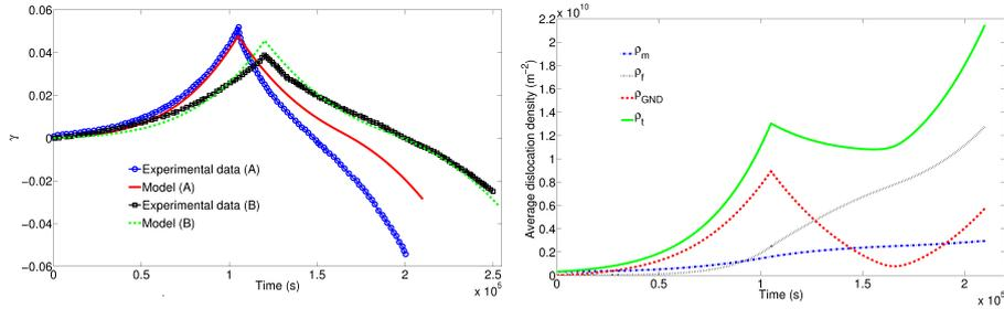
FIGURE 1.7 – A gauche : courbes de fluage expérimentales et simulées pour les monocristaux A et B.  $\gamma$  représente la déformation de cisaillement macroscopique. A droite : évolution des densités moyennes  $\rho_m$ ,  $\rho_f$ ,  $\rho_{GND}$  et  $\rho_t$  cumulées sur tous les systèmes de glissement au cours de l'essai A.
