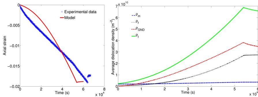
FIGURE 1.9 – A gauche : courbes de fluage expérimentale et simulée pour le multicristal. A droite : évolution des densités moyennes  $\rho_m$ ,  $\rho_f$ ,  $\rho_{GND}$  et  $\rho_t$  cumulées sur tous les systèmes de glissement au cours de la compression du multicristal.
