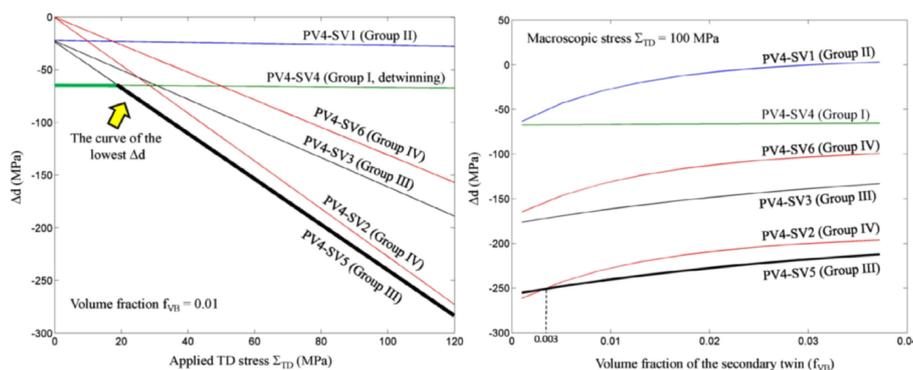
FIGURE 3.9 – Variation de l'énergie libre normalisée,  $\Delta d$ , pour les différentes variantes de macle secondaire en fonction de la contrainte appliquée lors de la seconde compression et en fonction de la fraction volumique de macle secondaire.
