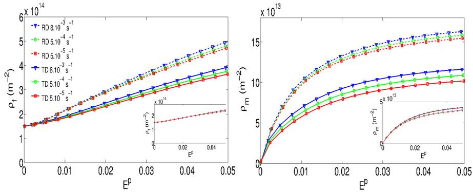
FIGURE 3.15 – Evolution des densités moyennes de dislocations immobiles et mobiles cumulées sur les 30 systèmes d'après le modèle. En encart : résultats des simulations avec les mêmes valeurs de  $n$  et  $C_1$  sur toutes les familles de glissement.
