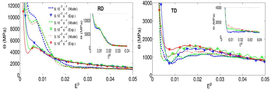
FIGURE 3.12 – Comparaisons des évolutions des taux d'érouissage entre expériences et simulations. En encart : résultats des simulations avec les mêmes valeurs de  $n$  et  $C_1$  sur toutes les familles de glissement ( $n = 50$  et  $C_1 = 1.5 \cdot 10^{-4}$ ).
