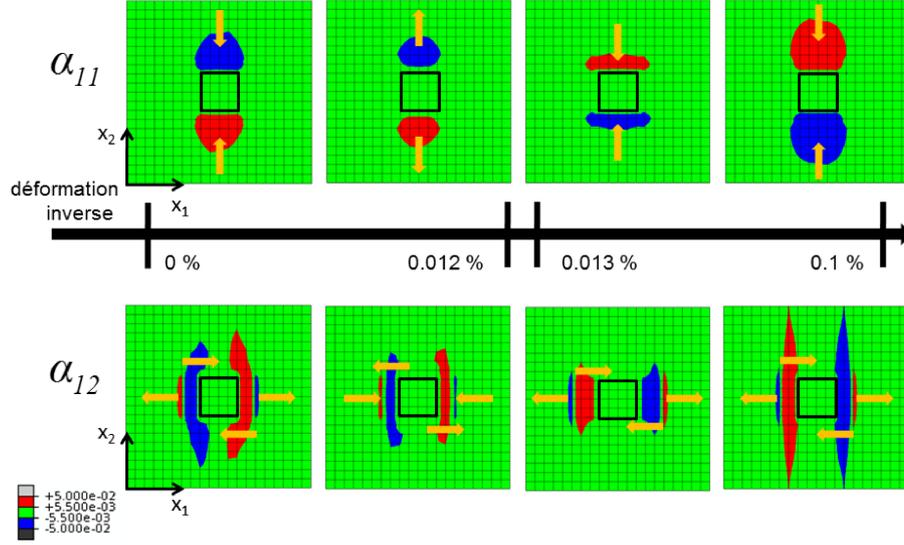
FIGURE 1.5 – Distribution des densités  $\alpha_{11}$  et  $\alpha_{12}$  (en  $mm^{-1}$ ) lors du chargement inverse autour d'une particule de taille  $20 * 20 * 20 \mu m^3$ . Les flèches indiquent les directions des vitesses de dislocations.
