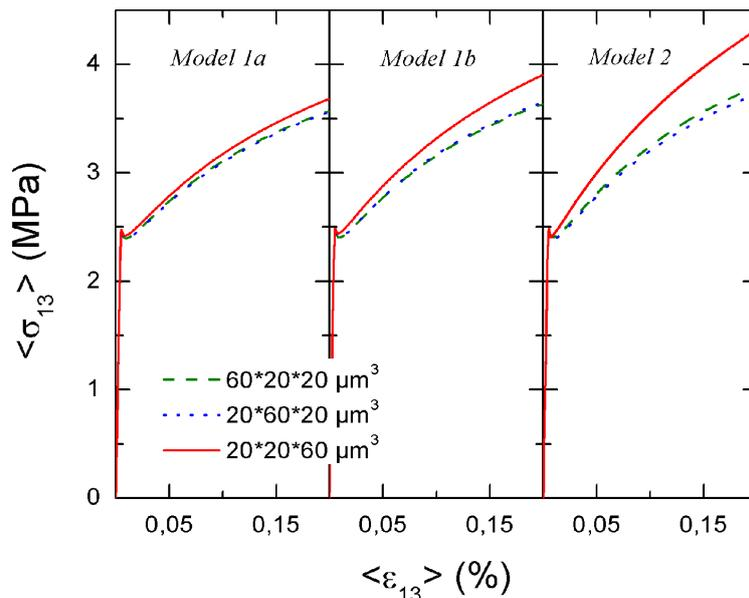
FIGURE 1.3 – Courbes contrainte-déformation obtenues par les 3 modèles pour différentes morphologies de particules de fraction volumique 2.4%.
