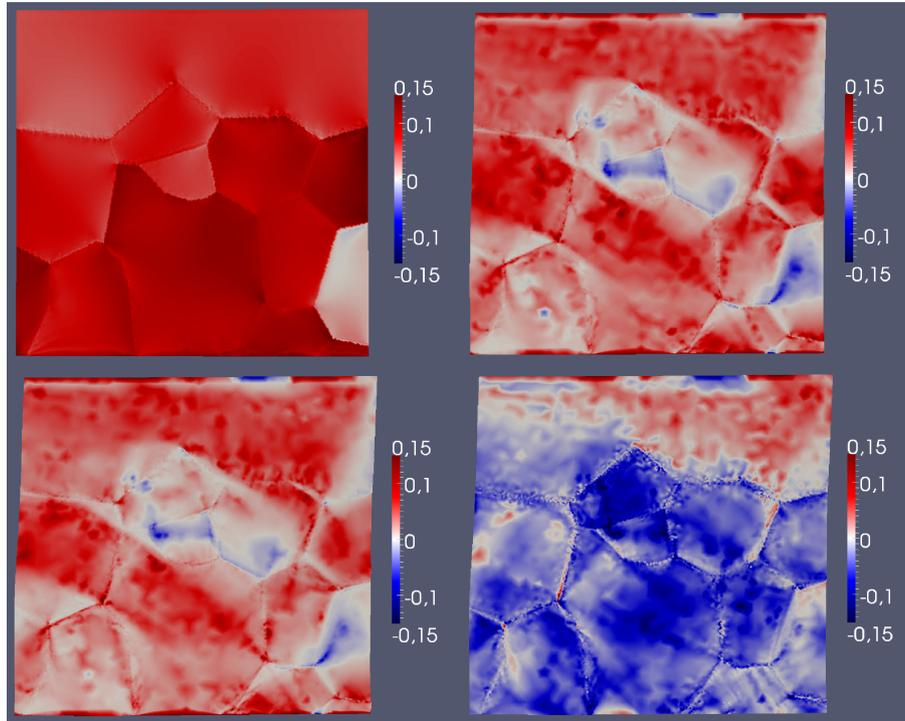
FIGURE 1.13 – Distribution de la cisssion résolue sur le système basal labellisé 1,  $\tau^{(1)}$ , en  $MPa$ , juste après le chargement, à  $-1\%$  de déformation macroscopique, juste avant la décharge à  $-1.9\%$  et juste après la décharge.
