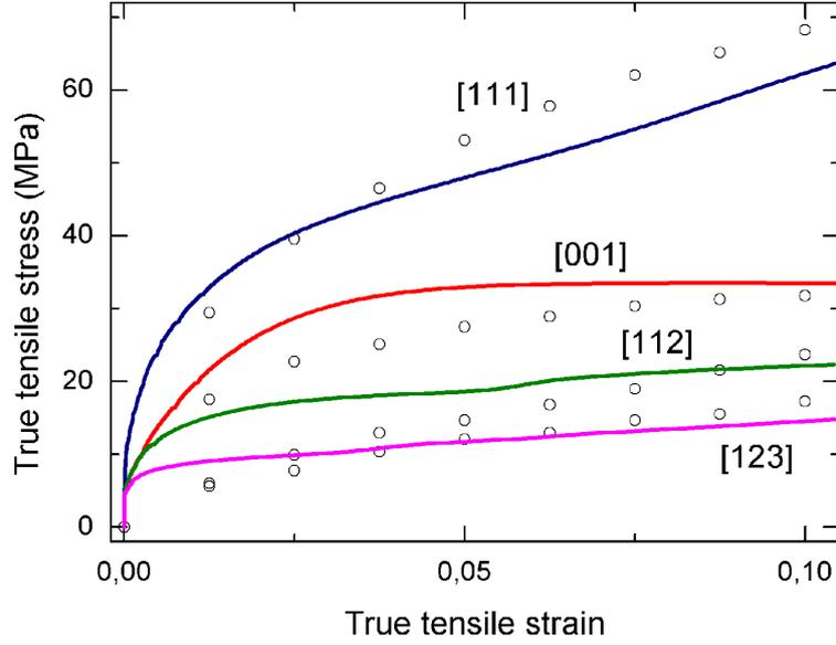
FIGURE 1.2 – Comparaisons des courbes contrainte-déformation de monocristaux d’Al de différentes orientations obtenues par Hosford *et al.* à 273 K [HFB60] (cercles ouverts) avec les résultats des simulations éléments finis du Modèle 1a (traits pleins).
