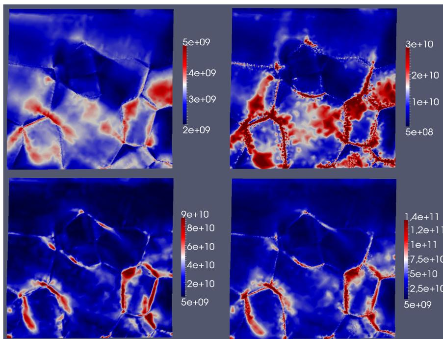
FIGURE 1.12 – Distribution des densités  $\rho_m$ ,  $\rho_f$ ,  $\rho_{GND}$  et  $\rho_t$  en  $m^{-2}$  cumulées sur tous les systèmes de glissement à  $-1\%$  de déformation macroscopique (de gauche à droite et de haut en bas, respectivement).
