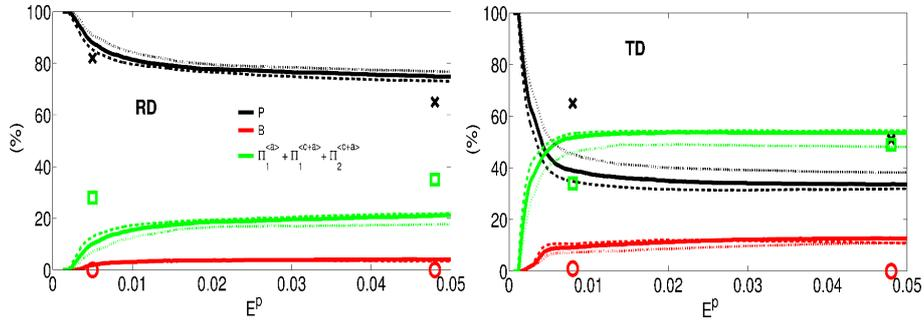
FIGURE 3.14 – Fréquence d’observation des familles de glissement estimée par le modèle pour différentes vitesses :  $5 \cdot 10^{-5} \text{ s}^{-1}$  (lignes en tirets),  $5 \cdot 10^{-4} \text{ s}^{-1}$  (lignes pleines),  $8 \cdot 10^{-3} \text{ s}^{-1}$  (lignes en pointillés). Les points sont les valeurs expérimentales à  $5 \cdot 10^{-4} \text{ s}^{-1}$  (en réalité, les valeurs mesurées à la striction correspondent à des déformation  $> 0.1$ ).
