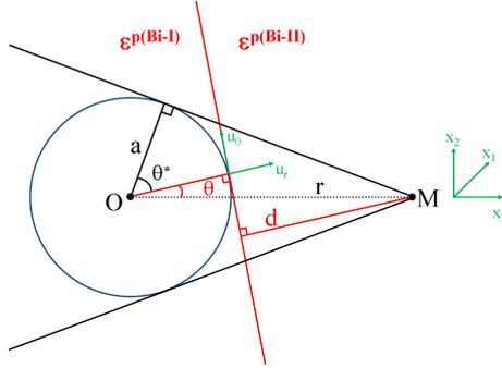
FIGURE 3.4 – Pour un point extérieur  $M(r, 0, 0)$ , tous les plans tangents avec  $0 < \phi < 2\pi$  et  $0 < \theta < \theta^* = \arccos(\frac{a}{r})$  contribuent avec  $\tilde{\varepsilon}^{p(Bi-II)}$ .
