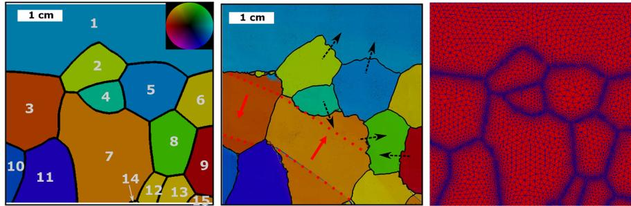
FIGURE 1.8 – A gauche : orientations de l’axe  $c$  mesurées avant et après déformation par AITA. Les lignes rouges en pointillés indiquent la présence d’une bande en genou qui traverse les grains 3 et 7. Les flèches rouges représentent les projections des directions de glissement basal labellisées 1 dans le plan de la figure. Les flèche noires en tirets indiquent les directions supposées des migrations de joint de grains. A droite : maillage utilisé dans la simulation EF du multicristal.
