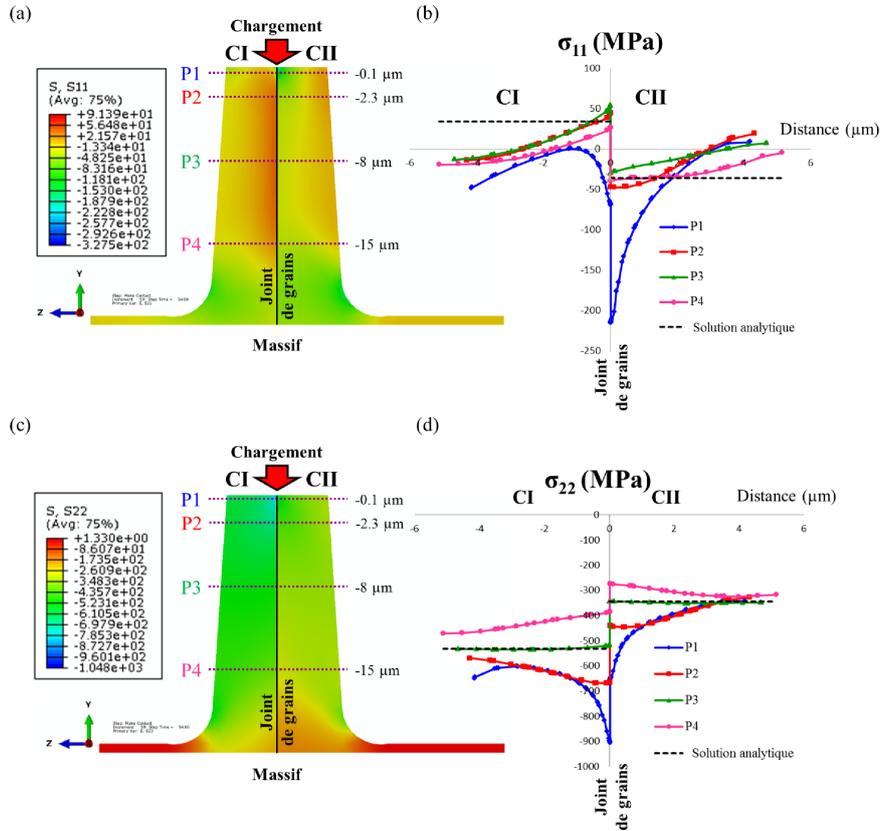
FIGURE 2.9 – Simulation EF du comportement du micropilier en élasticité pure. Variations des contraintes  $\sigma_{11}$  (a,b) et  $\sigma_{22}$  (c,d) le long de différents profils et comparaison avec la solution analytique.
