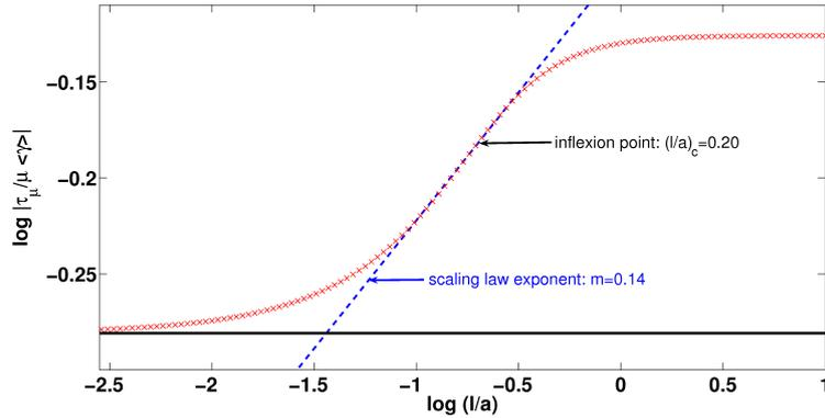
FIGURE 3.6 – Evolution de  $\tau_\mu$  avec le rapport  $l/a$  dans un diagramme  $log-log$ . La ligne noire horizontale représente la solution d’Eshelby.
