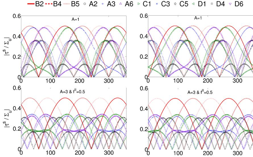
FIGURE 2.11 – Variations des cissions résolues dans le cristal parent (à gauche) et dans la macle (à droite) en élasticité en fonction de  $\psi$  pour  $\phi = 45^\circ$ , dans un cas sans contrainte d'incompatibilité ( $A = 1$ ) et un cas avec ( $A = 3$  et  $f^{II} = 0.5$ ).
