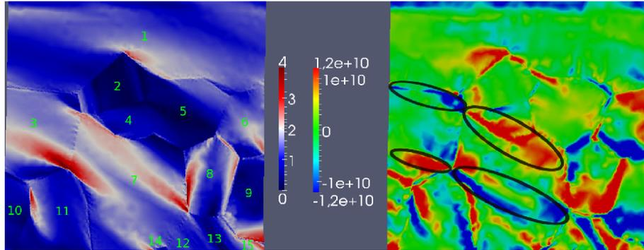
FIGURE 1.11 – A gauche : distribution simulée de la désorientation de l’axe  $c$  en degrés par rapport à l’orientation initiale à  $-1\%$  de déformation macroscopique. A droite : distribution de la densité de GND coins en  $m^{-2}$  associée au système basal labellisé 1.
