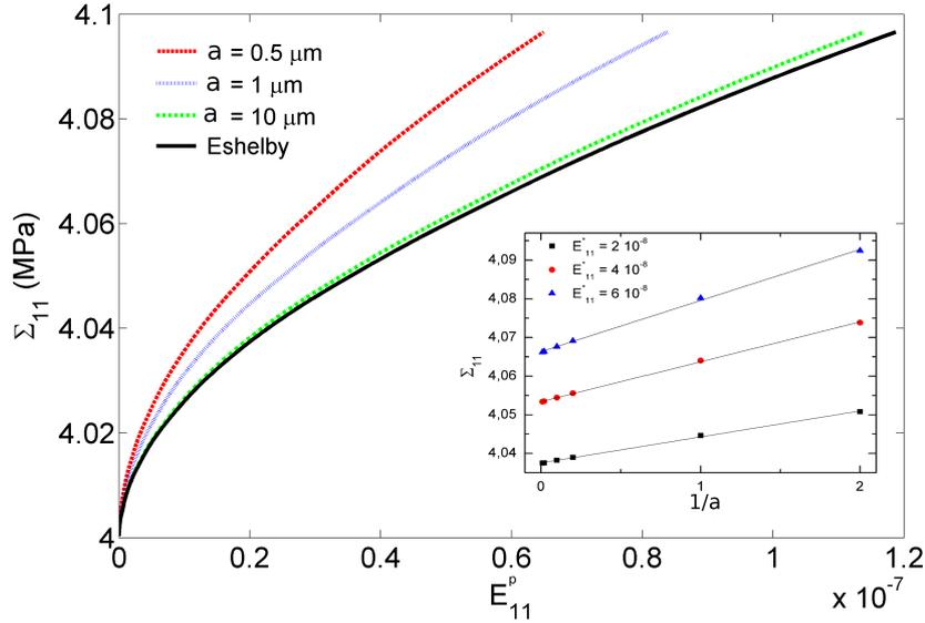
FIGURE 3.2 – Courbes contrainte-déformation plastique simulées pour différentes tailles de grain  $a$ . La courbe notée “Eshelby” représente la réponse du modèle Eshelby dilué. En encart : contraintes d’écoulement macroscopique en fonction de  $1/a$  pour trois niveaux de déformations plastiques.
