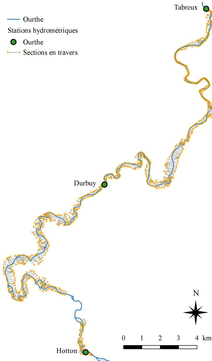
FIGURE 6.12 – Emplacement des sections en travers utilisées dans le modèle hydraulique.
