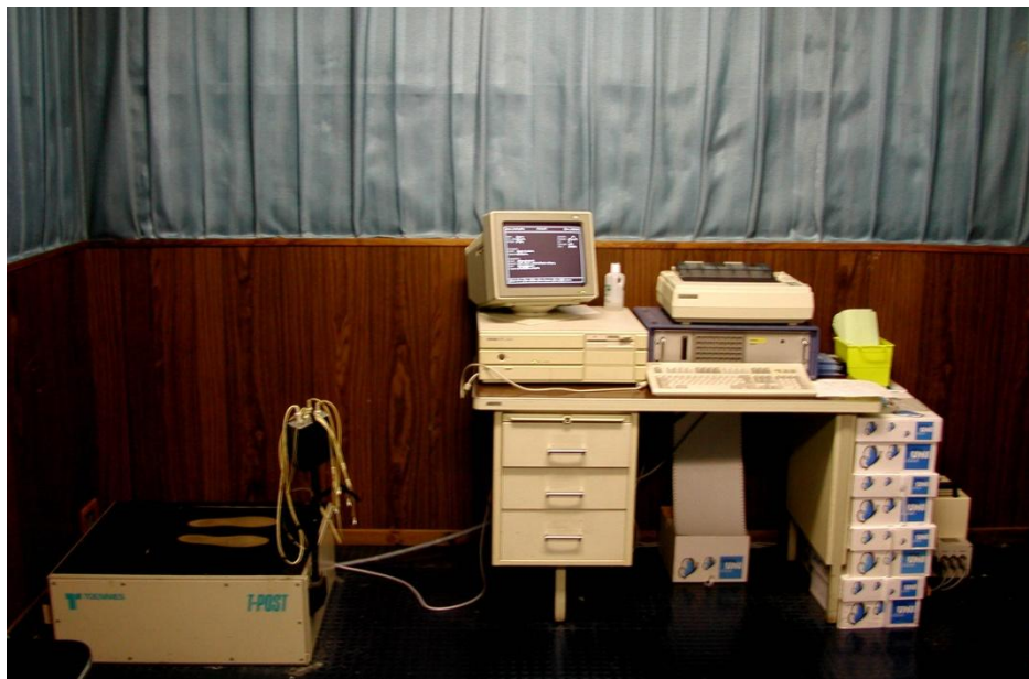
Figure 18 : Plate-forme Toennies (Toennies GmbH, Freiburg, Allemagne) utilisée pour les tests statiques et dynamiques avec oscillations lentes du plateau.
