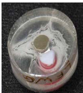
Figure 3.4 : Electrode deuxième génération G2
