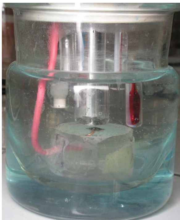
Figure 3.7 : photo de la cellule électrochimique et montage à trois électrodes
