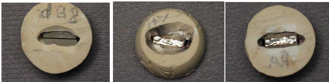
Figure 3.2 : échantillon pour soudure laser enrobé dans le plâtre pour maintenir l'espace du joint de soudure (à gauche), puis échantillons soudés au laser (au centre et à droite)
