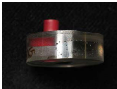
Figure 3.4 : Electrode deuxième génération G2
