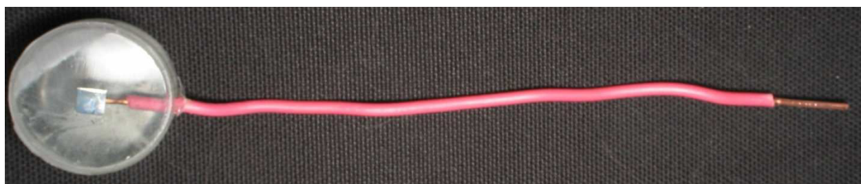
Figure 3.3 : Electrode de première génération G1
