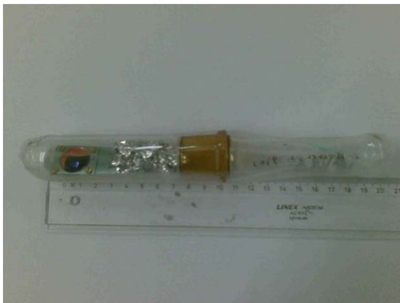
Figure V.6 : Porte-échantillon protégé dans une capsule en mylar tenue par un support en aluminium.
