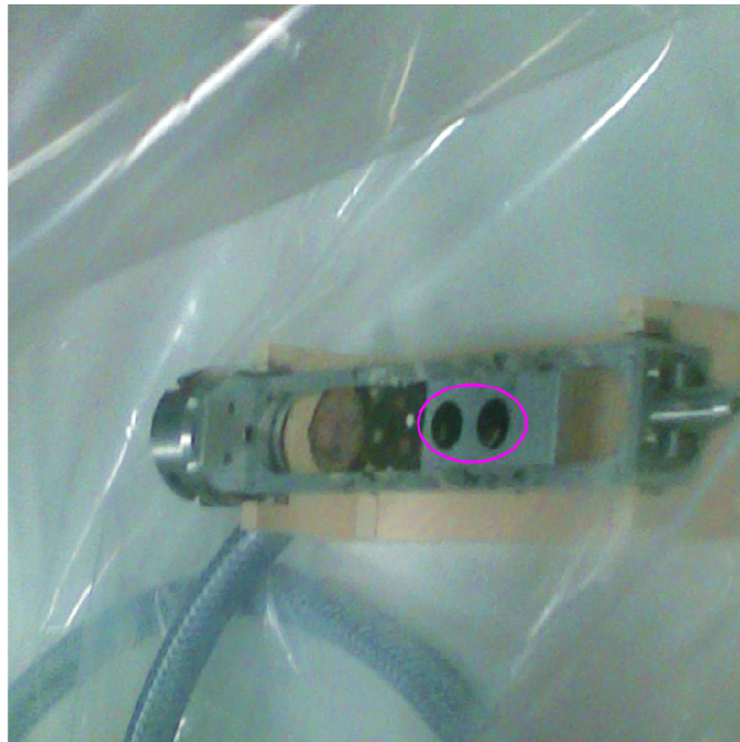
Figure III.3 : Préparation d'un porte-échantillon en sac à gants.
