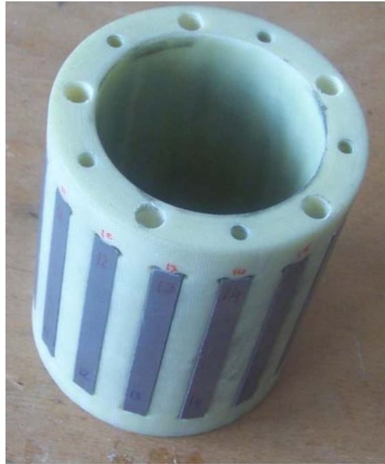
Fig. IV.8 Rotor intermédiaire (Pièces polaires ferromagnétiques mises sur son porte- pièces polaires ferromagnétiques)
