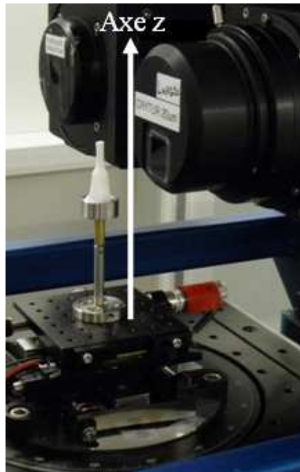
Figure D.3 : Photographie d'un échantillon de PEHD mis en place sur la plate-forme, devant le détecteur. L'axe vertical z correspond à l'axe de traction.
