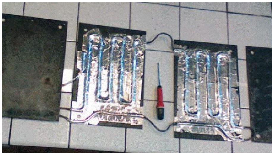
Figure 23. Vue de la position du cordon chauffant sur les plaques
