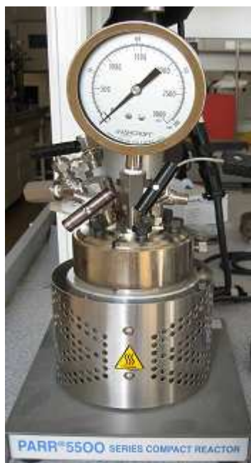
Figure 73: Réacteur à haute pression : dispositif pour la mesure de la croissance bactérienne sous pression croissante (1 à 45 bars)
