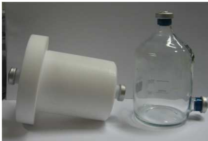
Figure 29 : Photos des deux réacteurs en téflon et en verre. 2 sorties avec septum permettent de créer des conditions réductrices (balayage gazeux) et de réaliser des prélèvements de gaz et de solution au cours du temps, de façon stérile.
