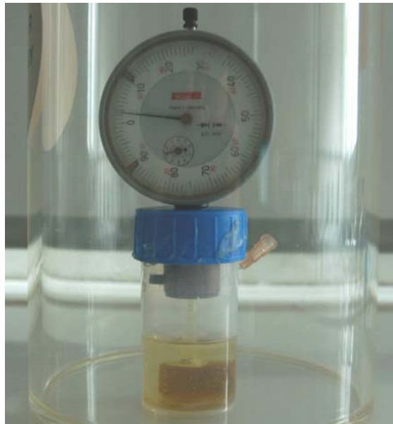
Figure 85 : Module expérimental de mesure de gonflement du GIH-nontronite par un palper en condition anoxique en jarre (N 2 90% CO 2 10%)
