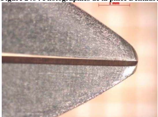
Figure 247 : Photographies de la pince ETM® n°1, état neuf et après 20 cycles (grossissement x25)
