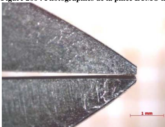
Figure 267 : Photographies de la pince ETM® n°21, état neuf et après 20 cycles (grossissement x25)
