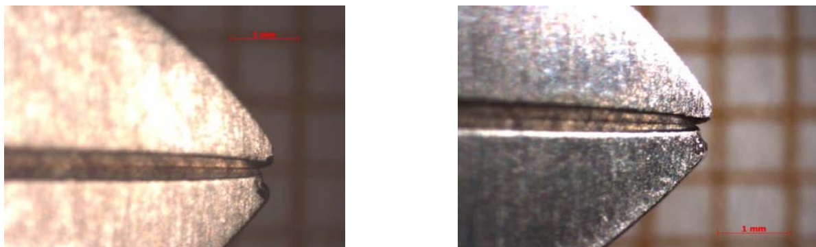
Figure 116 : Photographies de la pince Dentaurum® n°15, initiale et après 20 cycles
