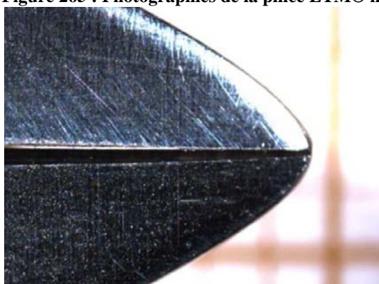
Figure 266 : Photographies de la pince ETM® n°20, état neuf et après 20 cycles (grossissement x25)
