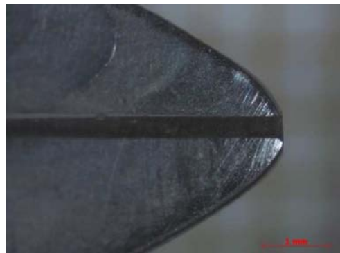
Figure 108 : Photographie de l'état initial de la pince ETM® n°16 (grossissement x50)
