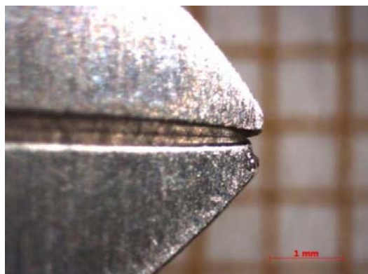
Figure 236 : Photographies de la pince Dentaurum® n°15, état neuf et après 20 cycles (grossissement x25)
