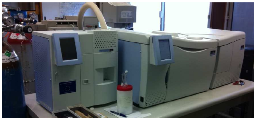
Figure 27 : Spectromètre Turbo Mass Clarus 500 de Perkin Elmer®
