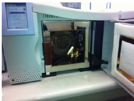
Figure 28 : Vue de la colonne du spectromètre
