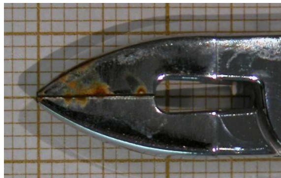
Figure 6 : Photographie d'une pince à couper les ligatures après 20 cycles de stérilisation
