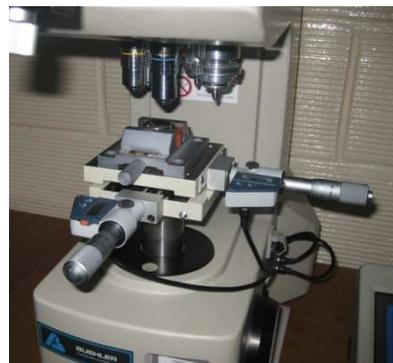
**Figure 22 : Duromètre BUEHLER® Micromet 5104**
