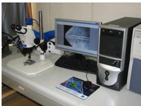
Figure 36 : Loupe binoculaire numérique ZEISS®
