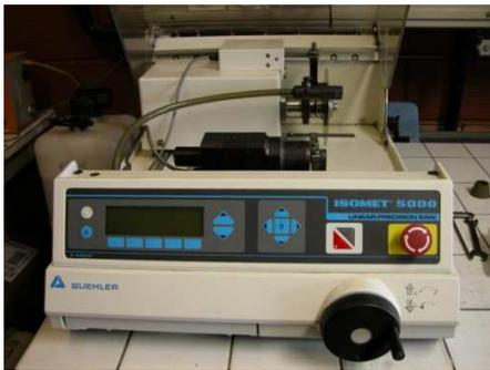
**Figure 20 : Scie circulaire BUEHLER® Isomet 5000**
