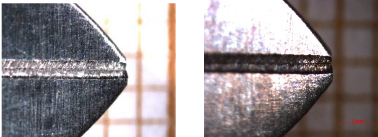
Figure 223 : Photographies de la pince Dentaurem® n°2, état neuf et après 20 cycles (grossissement x25)
