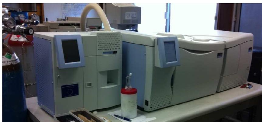
**Figure 27 : Spectromètre Turbo Mass Clarus 500 de Perkin Elmer®**
