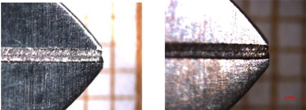
**Figure 223 : Photographies de la pince Dentaaurum® n°2, état neuf et après 20 cycles (grossissement x25)**
