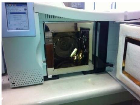
**Figure 28 : Vue de la colonne du spectromètre**
