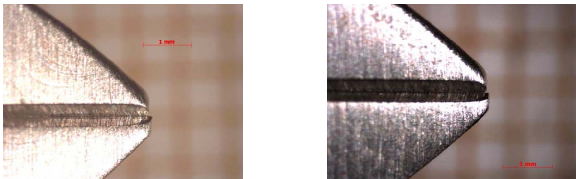
Figure 120 : Photographies de la pince RMO® n°19, initiale et après 20 cycles (grossissement x50)
