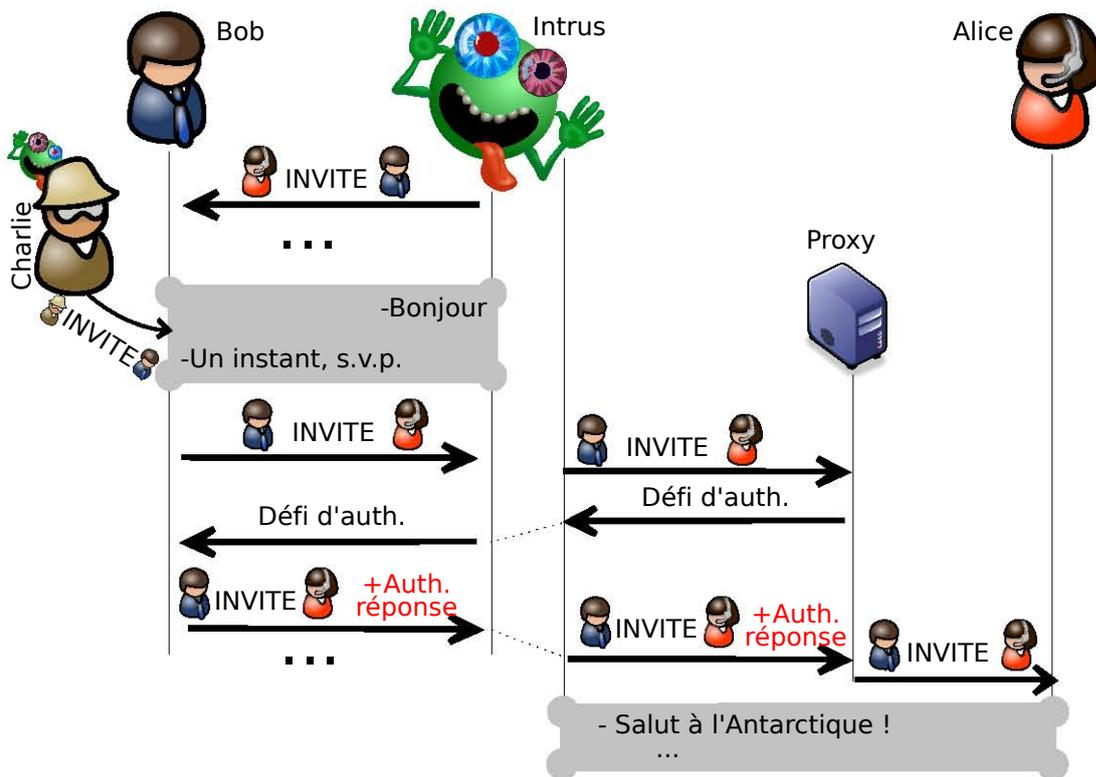
Figure 1: Attaque sur protocole SIP
