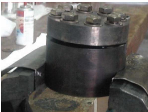
Figure 20 - Photo de l'autoclave à joint chaud chemisé en or développé par Nguyen-Trung (1980).
