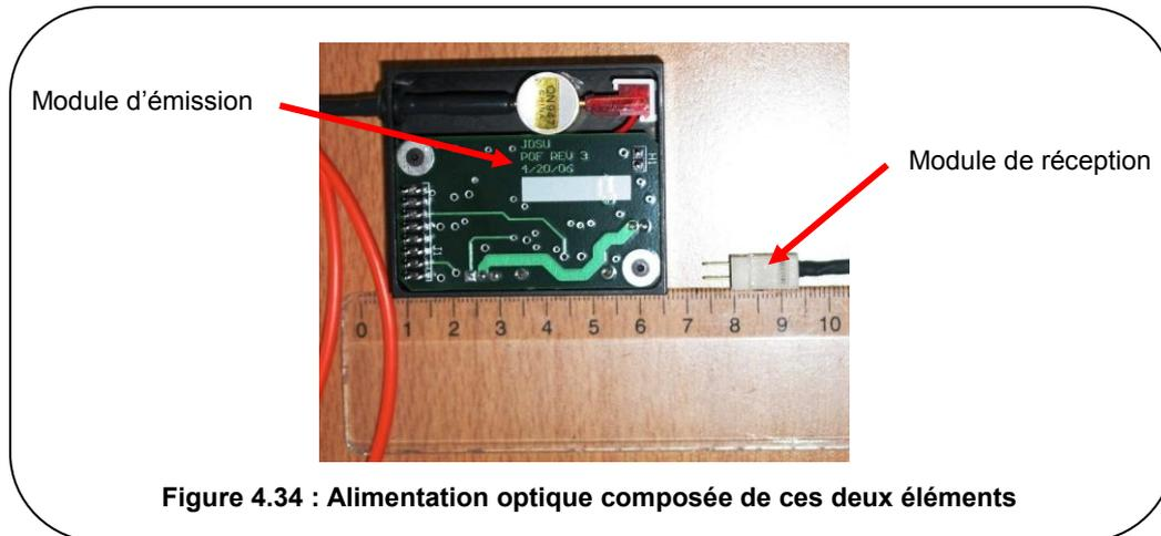
Figure 4.34 : Alimentation optique composée de ces deux éléments
