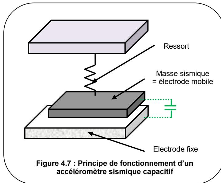
La masse sismique est en fait une électrode mobile qui ajoutée à une partie fixe du système (électrode fixe) forme une capacité. Le principe de la méthode capacitive repose donc sur la mesure des variations de capacité observées lorsque la masse sismique s'éloigne ou se rapproche de la partie fixe sous l'effet de l'accélération.
