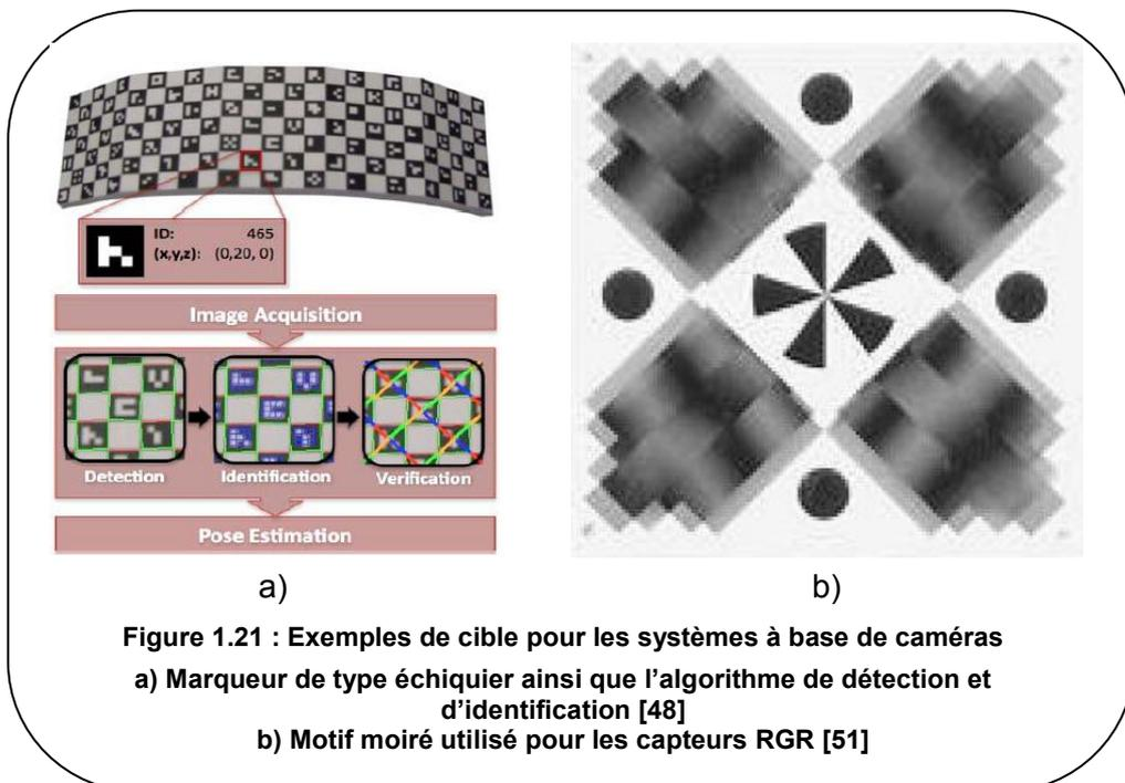
Figure 1.21 : Exemples de cible pour les systèmes à base de caméras
