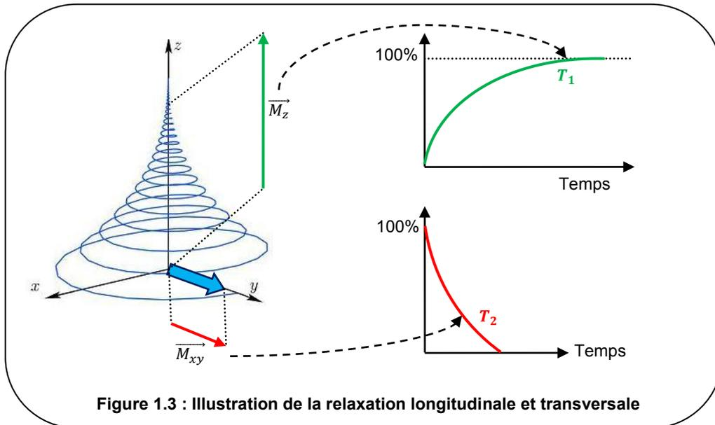
A l'arrêt du phénomène de résonance, la composante transversale de l'aimantation  $\vec{M}$  décrit une spirale dans le plan  $xOy$ . Cette rotation induit un champ magnétique, qui peut ensuite être recueilli sous forme de signal électrique grâce à une bobine placée à proximité (Figure 1.4). Le signal obtenu est appelé FID (*Free Induction Decay*) et correspond théoriquement à la courbe de décroissance de l'aimantation transversale (décroissance en  $T_2$ ).
