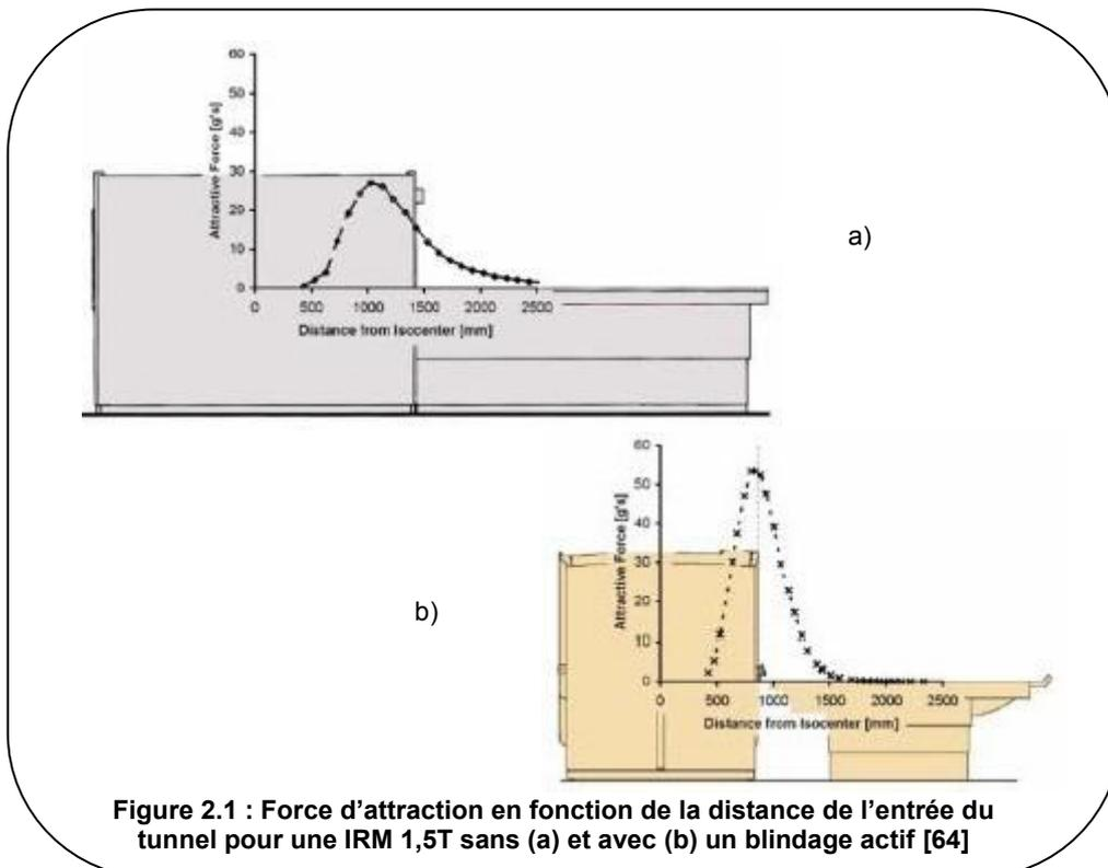
Figure 2.1 : Force d'attraction en fonction de la distance de l'entrée du tunnel pour une IRM 1,5T sans (a) et avec (b) un blindage actif [64]
