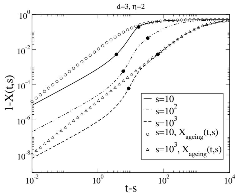
FIGURE 2.9 – Rapport fluctuation-dissipation  $X(t, s)$  en trait plein et sa valeur limite dans le régime de vieillissement  $X_{\text{ageing}}(t, s)$  représenté par des symboles. Ce rapport est tracé en fonction du temps de séparation  $t - s$  pour différentes valeurs du temps d'attente  $s$  dans le cas du BCPD en 3 dimensions.
