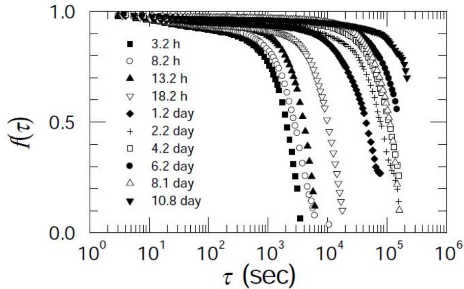
FIGURE 1.2 – Facteur de structure d'un gel colloïdal en fonction du temps de séparation  $\tau = t - s$ . Il a été mesuré après que le système a été mis hors équilibre suivant un protocole chimique [Cipe00].
