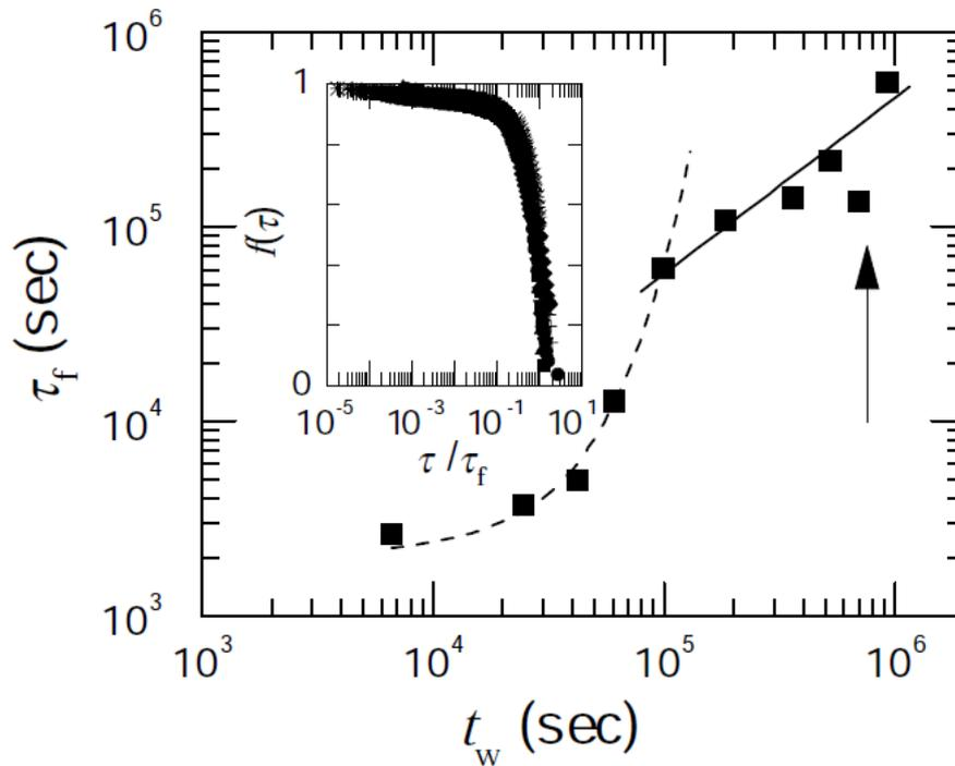
FIGURE 1.4 – Dans l’insert, la fonction d’échelle du facteur de structure est tracée en fonction de la variable d’échelle  $\tau/\tau_f$ . La dépendance de cette variable  $\tau_f$  est quant à elle représentée dans la figure principale en fonction du temps d’attente  $t_w$ . Tiré de [Cipe00].
