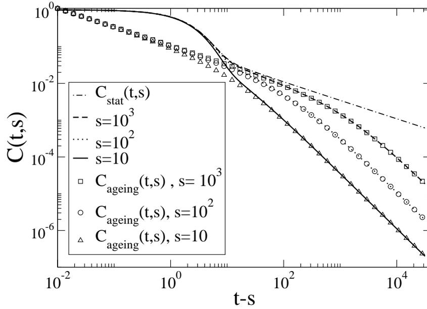
FIGURE 2.4 – Autocorrélateur  $C(t, s)$  du processus de contact bosonique avec  $\eta = 2$  en  $3D$ . Il est représenté comme une fonction du temps de séparation  $t - s$ , pour différentes valeurs du temps d'attente  $s$ . Les lignes en trait plein représentent le corrélateur total, les lignes pointillées représentent le corrélateur stationnaire de l'eq. (2.62) et enfin les symboles les contributions d'échelle  $C_{\text{ageing}}(t, s) = s^{-b} f_C(t/s)$ .
