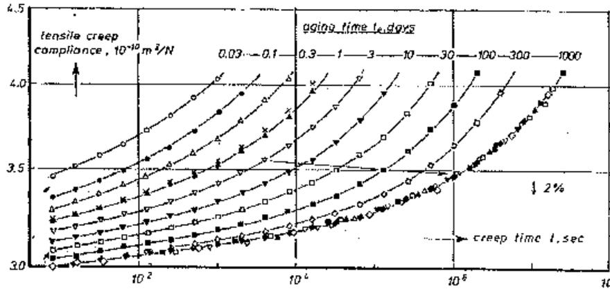
FIGURE 1.1 – Mesure de la complaisance pour un PVC trempé de  $90^\circ\text{C}$  à  $20^\circ\text{C}$ . La flèche indique la translation horizontale nécessaire pour superposer chaque courbe. Tiré de [Stru78].
