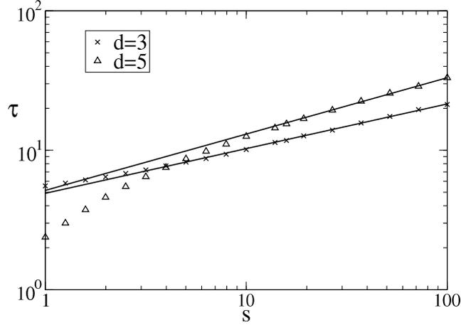
FIGURE C1 – Temps de passage vers le régime de vieillissement dans le modèle sphérique à la température critique  $T = T_c$ . Il est représenté en fonction du temps d'attente  $s$  pour différentes valeurs de la dimension  $d$ . La courbe en trait plein représente la courbe de tendance  $\tau_{\text{ageing}}(s) = 4.9 \cdot s^{0.32}$  pour  $d = 3$  et  $\tau_{\text{ageing}}(s) = 5.2 \cdot s^{0.40}$  dans le cas où  $d = 5$ .
