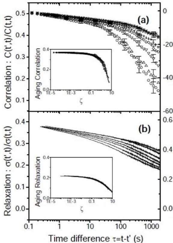
FIGURE 1.9 – En haut, susceptibilité (en haut) et corrélateur (en bas) en fonction du temps de séparation pour différents temps d'attente  $s = [100, 200, 500, 1000, 2000, 5000, 10000]$ . Les temps d'attente sont donnés en seconde et correspondent respectivement aux courbes de haut en bas. L'insert montre le sous-vieillessement avec un exposant  $\mu = 0.78$ . Tiré de [Heri02].
