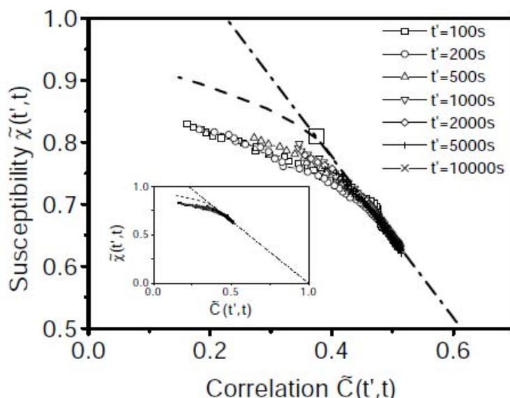
FIGURE 1.10 – La brisure du théorème fluctuation dissipation apparaît sur ce graphe. La ligne en tiret montre la valeur attendue pour  $s \rightarrow \infty$ . La courbe correspondant au théorème fluctuation-dissipation est donnée en tiret-pointillé. D'après [Heri04].
