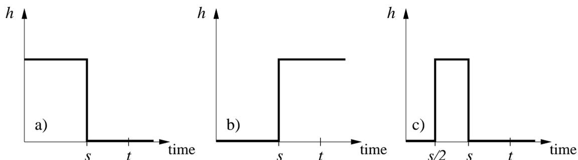
FIGURE A1 – Plusieurs protocoles pour mesurer des susceptibilités intégrées. On voit la dépendance temporelle de l'amplitude  $h_0$  du champ magnétique spatialement aléatoire  $h$ . (a) thermorémanente (TRM) (b) "zero-field cooled" (ZFC) et (c) intermédiaire (Int). Tiré de [Henk10]
