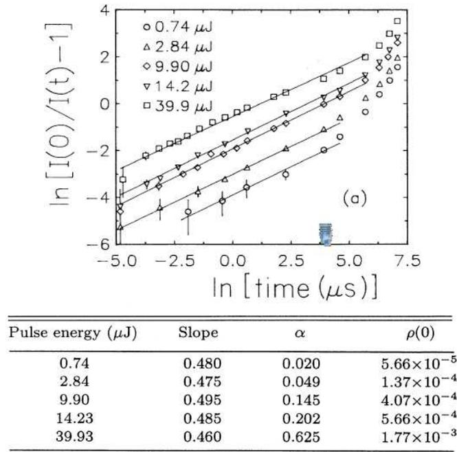
FIGURE 3.3 – La figure représente les variations de l'inverse de l'intensité  $I(t)$  (émise lors de la fusion de deux excitons) en fonction du temps dans un plot In-In. On peut observer la partie algébrique et la valeur de la pente de chacune des droites est donnée dans le tableau. Etant donné les valeurs, il est possible d'ajouter que le comportement algébrique est indépendant de l'intensité initiale  $I(0)$ . Tiré de [Kroo93].
