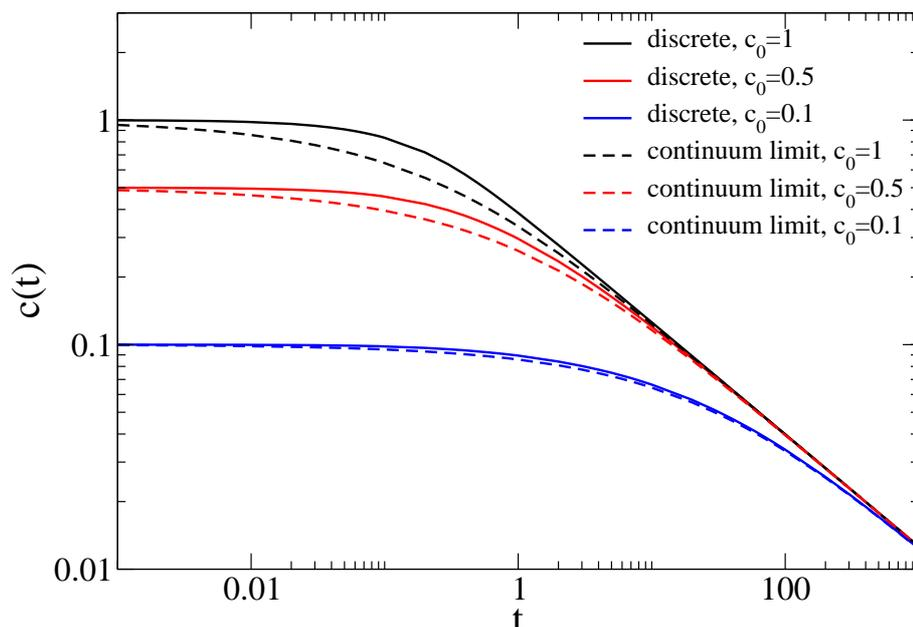
FIGURE 3.6 – Évolution de la concentration dans le cas discret (en trait plein) et dans le cas continu (pointillé). Les concentrations initiales  $c_0$  choisies sont  $[1, 0.5, 0.1]$  en allant du haut vers le bas.
