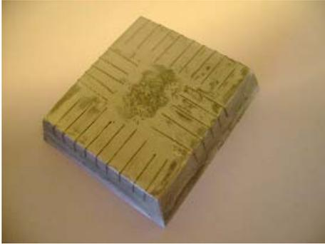
FIG. C.2: Support pour polissage
