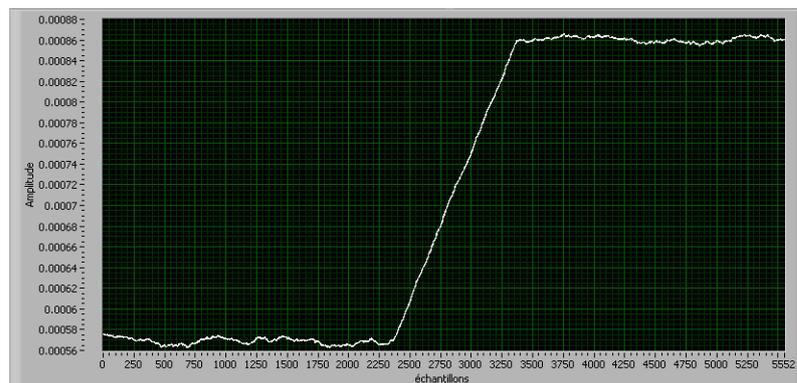
FIG. D.6: Détection de l'augmentation du signal utile par détection synchrone
