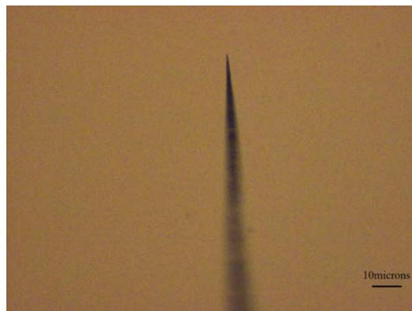
FIG. C.13: Pointe AFM en tungstène après attaque chimique, microscopie optique
