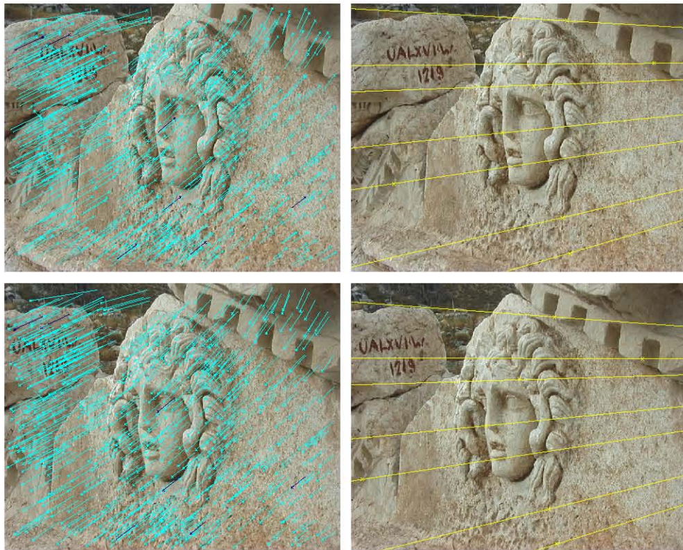
FIGURE 5.8 – medusa - Exemple de séquence sans motifs répétés pour ACM+F. Les deux images mises en correspondance sont disposées l'une sous l'autre. A droite, on peut voir le faisceau des droites épipolaires.
