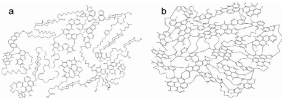
**Figure 3: Modèle structural d'un kérogène de type II (origine marine) au début de la diagénèse (a) et à la fin de la catagenèse (b), d'après Béhar *et al.* ([Béhar et al. 1987](#)).**
