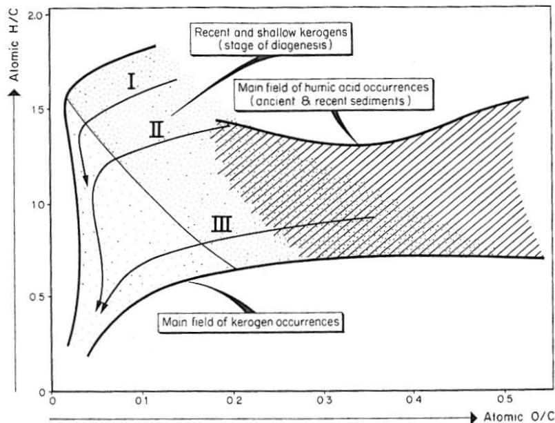
**Figure 2: Diagramme de Van Krevelen indiquant la composition élémentaire des trois principaux types de kérogène au début de la diagenèse et leurs évolutions chimiques jusqu'au stade de métagenèse (d'après Tissot et Welte, 1984 ([Tissot et al. 1984](#)))**
