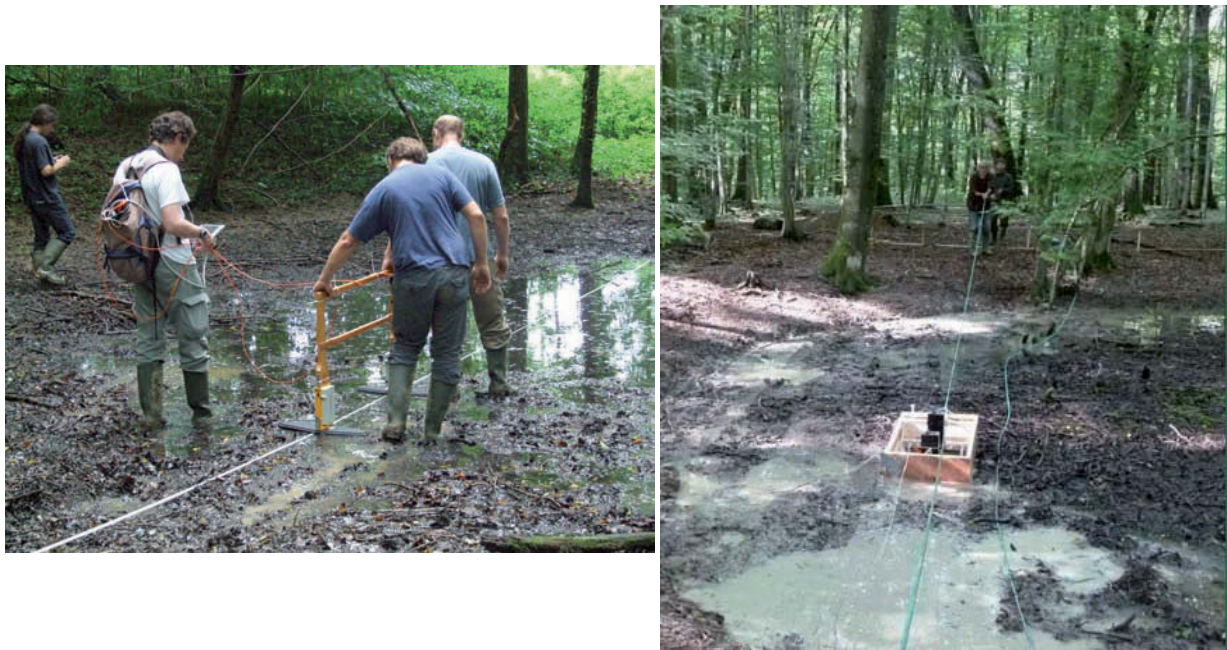
Figure 2.6 - Photographies des prospections au radar sol (antennes GPR 200 MHz) sur une mardelle prospectable (a) et la version pour la prospection en milieux très humides (b) avec l'implantation du matériel dans un radeau. La mardelle prospectée (b) est celle de Dolving dont les résultats sont disponibles dans cette thèse ( cf. Chapitre 3 ).
