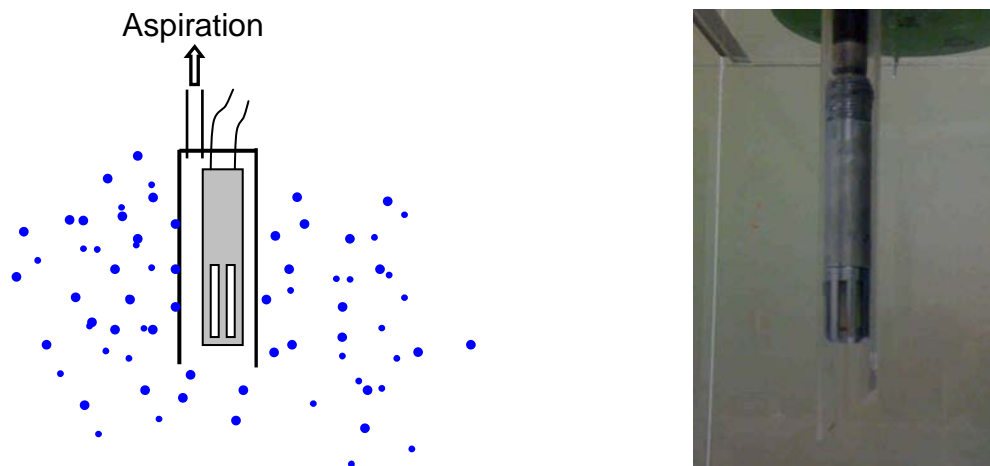
figure 4.17 - Représentation et photographie d'un hygromètre et de sa protection
