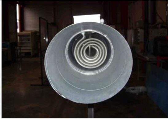
figure 4.5 - Photographie du système de chauffage de l'air
