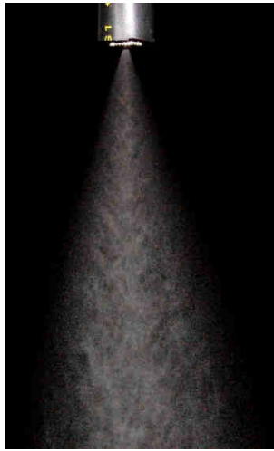
figure 4.21 - Photographie du spray à la sortie de la buse C01
