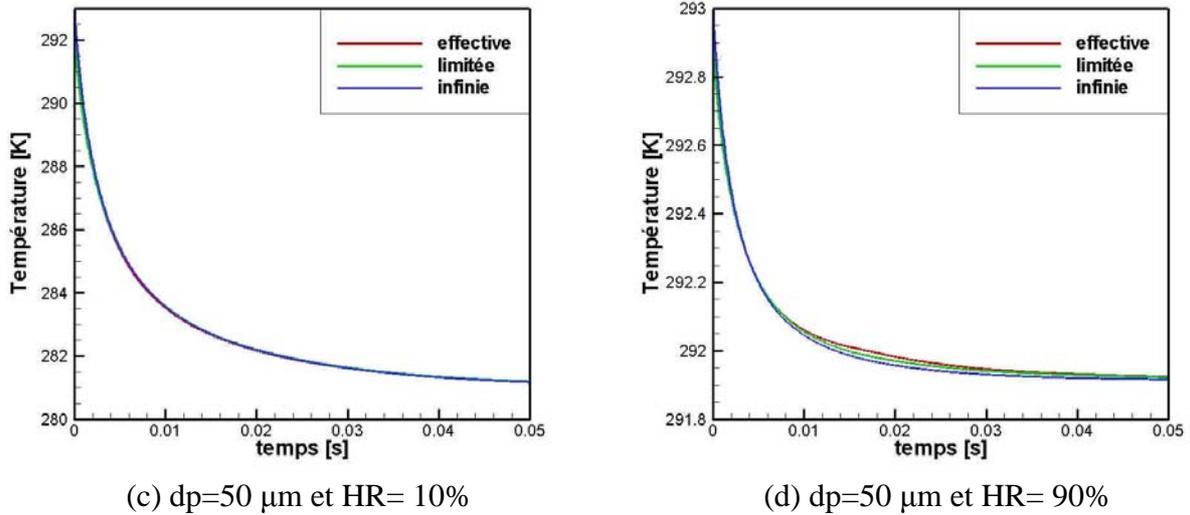
figure 1.3 - Influence du choix du modèle de conduction sur l'évolution de la température de la goutte en évaporation (conditions à  $t = 0$ ,  $T_f=293 \text{ K}$ ,  $T_p=293 \text{ K}$ ,  $V_{fx} = 2 \text{ m.s}^{-1}$ ,  $V_{px} = 50 \text{ m.s}^{-1}$ )
