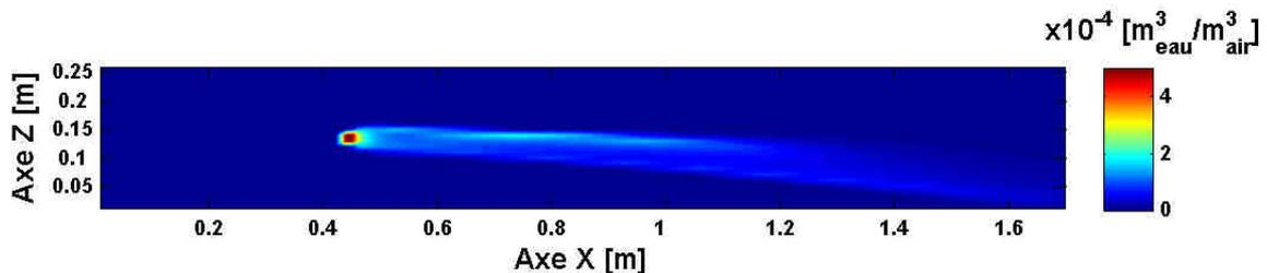
figure 2.6 - Fraction volumique d'eau liquide dans le plan XZ dans l'axe de la buse
