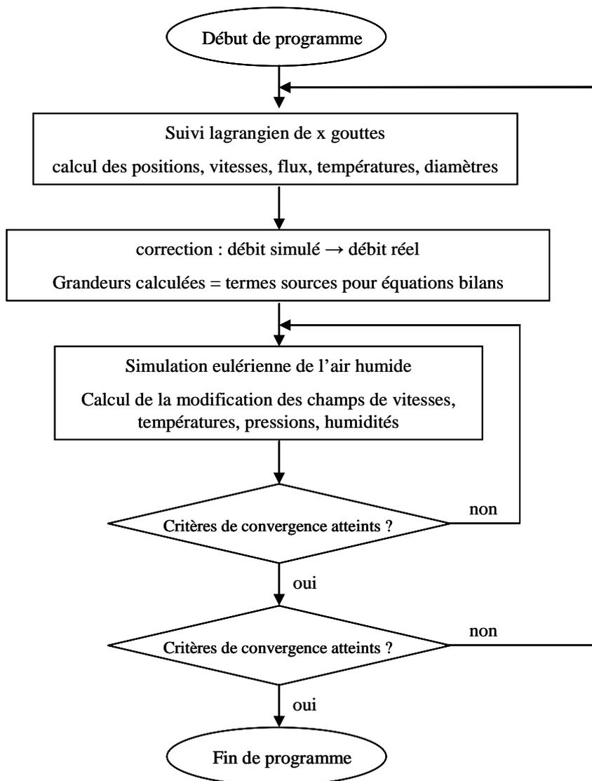
figure 1.12 - Algorithme du code de calcul MIRABELLES
