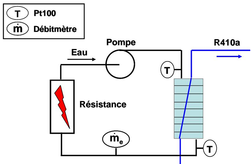
figure 6.3 - Schéma du circuit « source froide » et de son instrumentation
