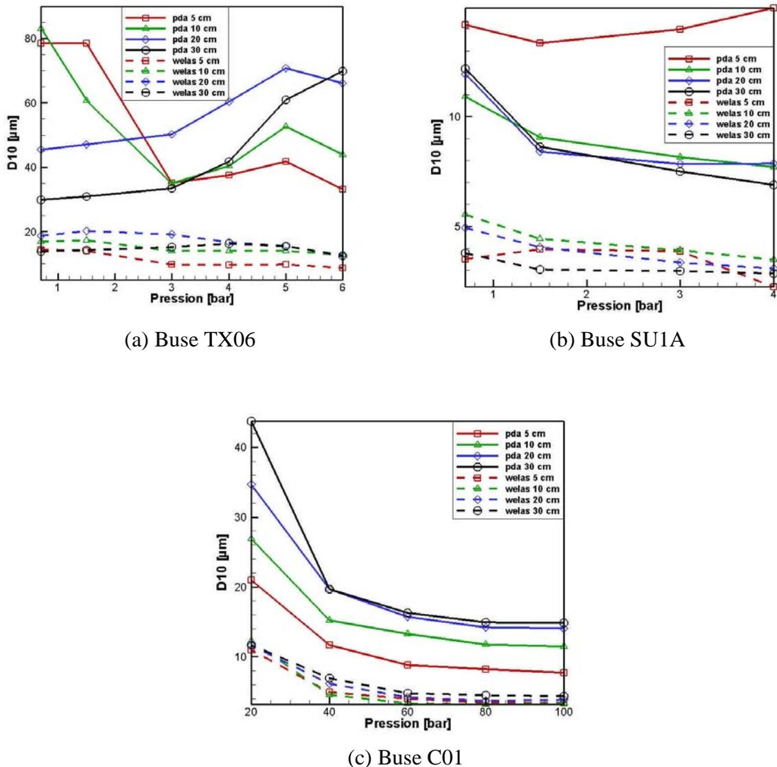
figure 4.27 - Représentation du diamètre moyen en fonction de la pression d'alimentation en eau/air mesuré avec le PDA et le Welas à différentes distances de la buse.
