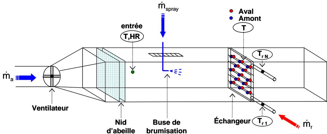
figure 4.10 - Représentation de la métrologie utilisée
