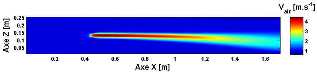
figure 2.13 - Vitesse de l'air dans le plan XZ dans l'axe de la buse
