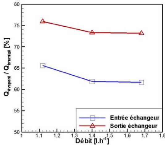
figure 5.11 - Fraction d'eau évaporée en fonction du débit de brumisation
