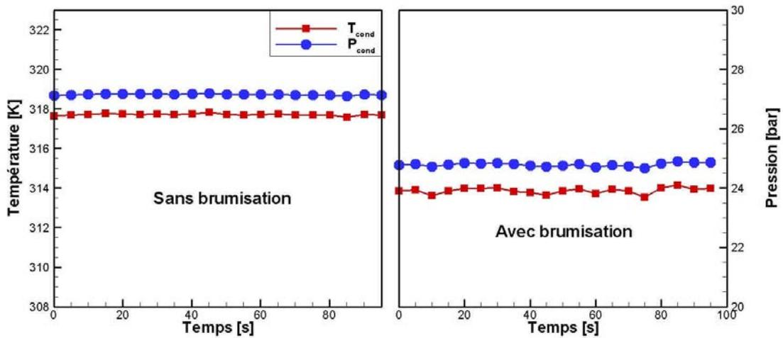
figure 6.10 - Température et pression de condensation
