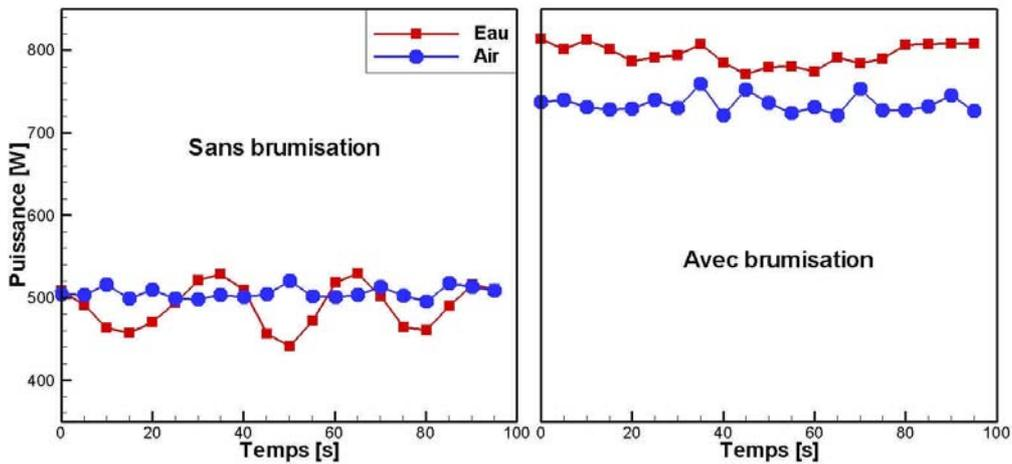
figure 5.6 - Puissances échangées côté eau et côté air avec et sans brumisation
