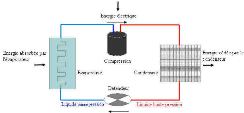
figure 1 - Principe d'une machine frigorifique mono-étagée
