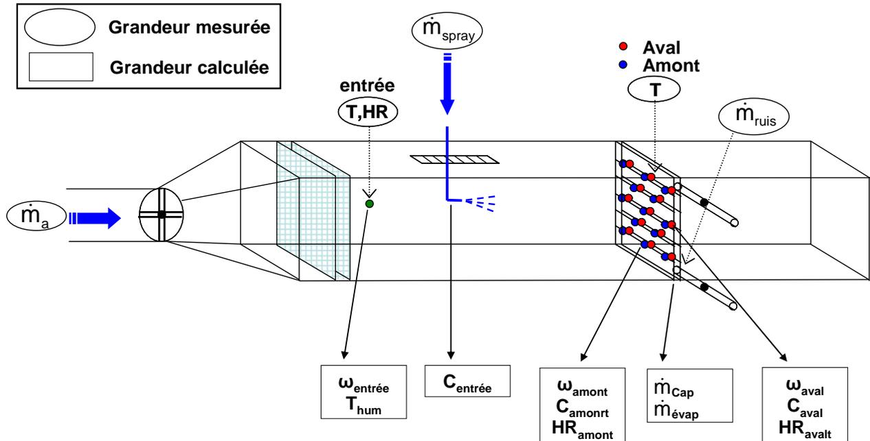
figure 4.19 - Représentation des grandeurs mesurées et calculées
