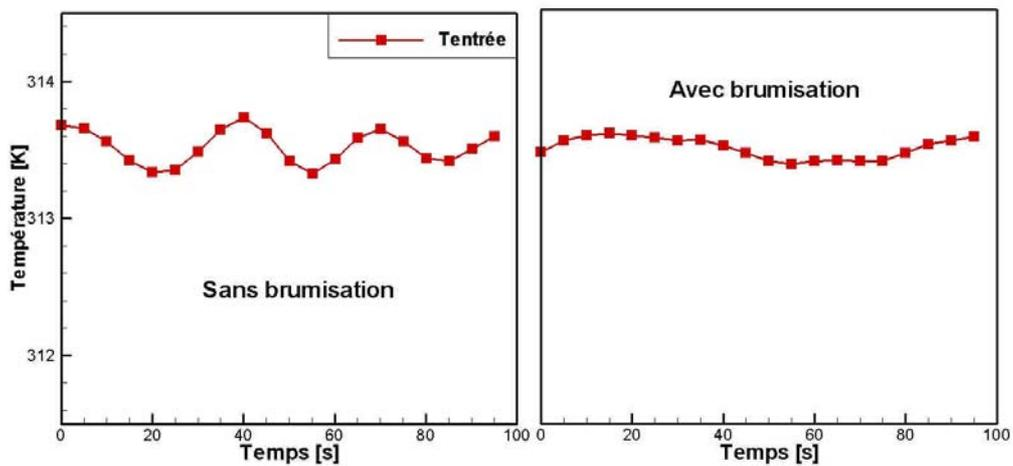
figure 5.3 - Température de l'eau à l'entrée de l'échangeur
