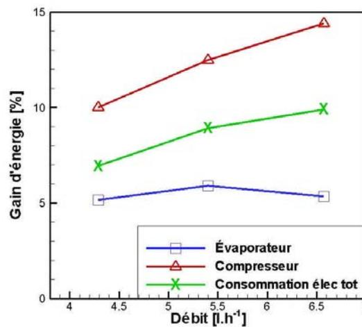
figure 6.19 - Gains d'énergie sur la machine frigorifique
