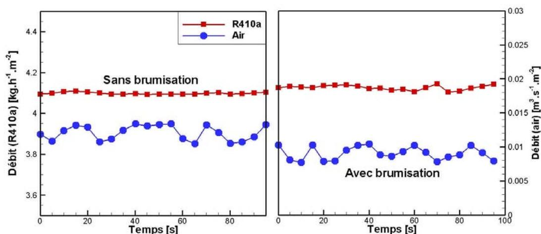
figure 6.9 - Débit d'air à l'entrée du système
