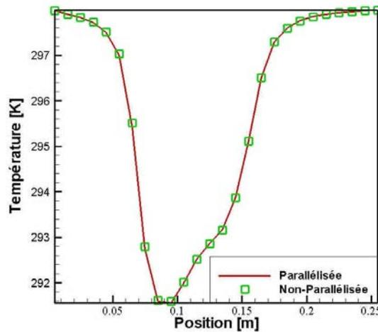
figure 1.23 - Comparaison de la température sur un axe pour une simulation avec et sans parallélisation
