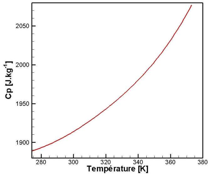
figure A.3 - Evolution de la capacité calorifique de la vapeur d'eau en fonction de la température
