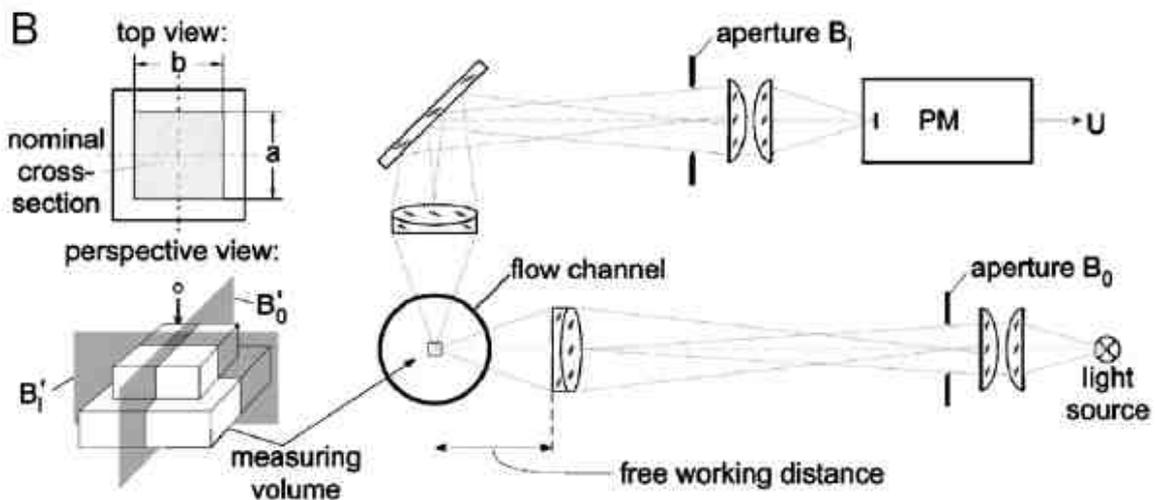
figure 4.23 - Principe de fonctionnement du granulomètre Welas
