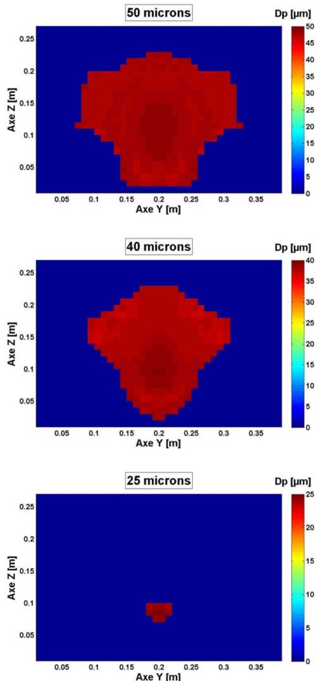
figure 2.15 - Représentation du diamètre moyen des gouttes dans le plan YZ en X = 142 cm
