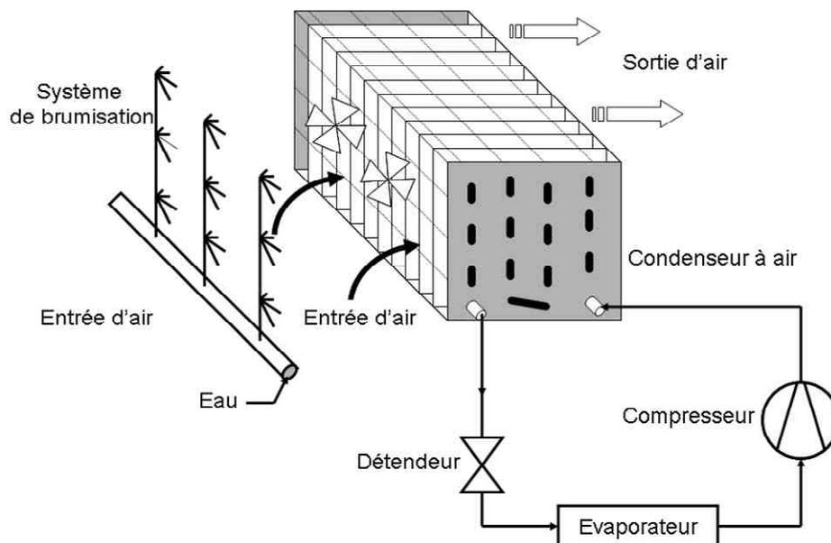
figure 4 - Schéma de principe de la brumisation d'un condenseur à air. [Youbi-Idrissi *et al.*, 2007]
