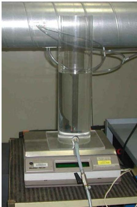
figure 4.9 - La balance et le réservoir d'eau
