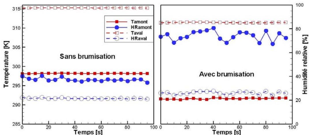
figure 6.8 - Température et humidité en amont et en aval de l'échangeur
