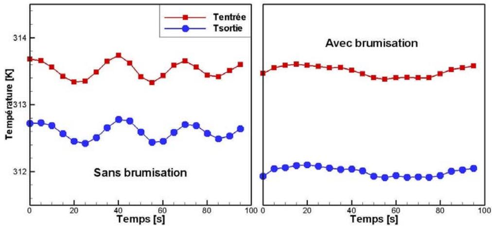
figure 5.5 - Température de l'eau en entrée et en sortie de l'échangeur
