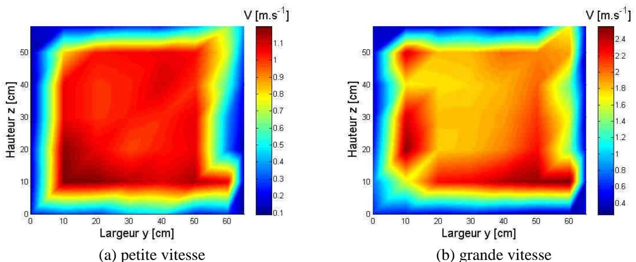
figure 6.6 - Vitesses d'air à l'entrée de la veine
