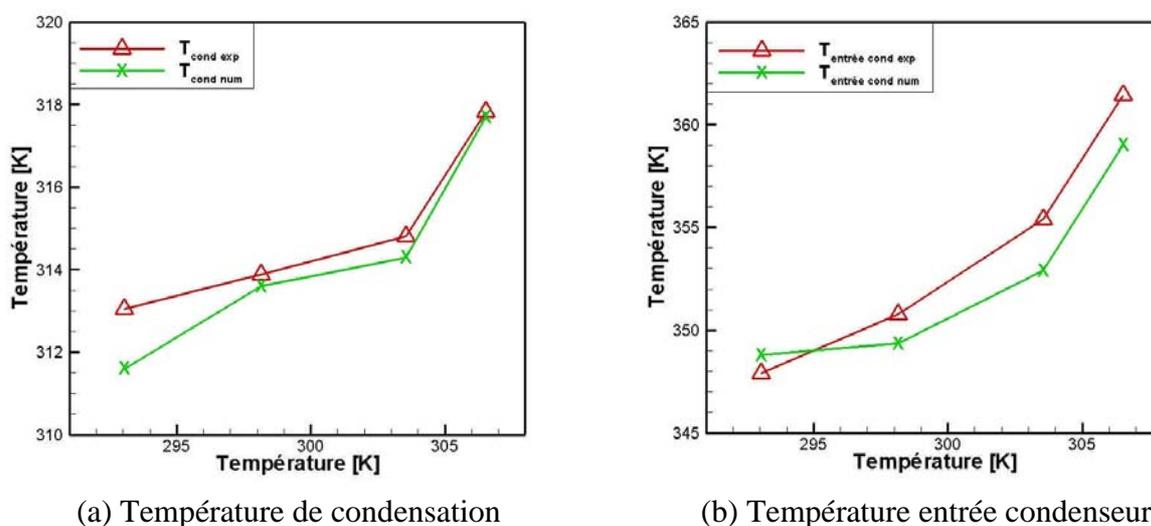
figure 6.33 - Température d'entrée dans le condenseur et de condensation du fluide frigorigène en fonction de la température d'entrée de l'air
