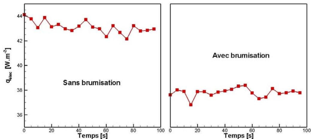
figure 6.14 - Puissance électrique consommée par le compresseur
