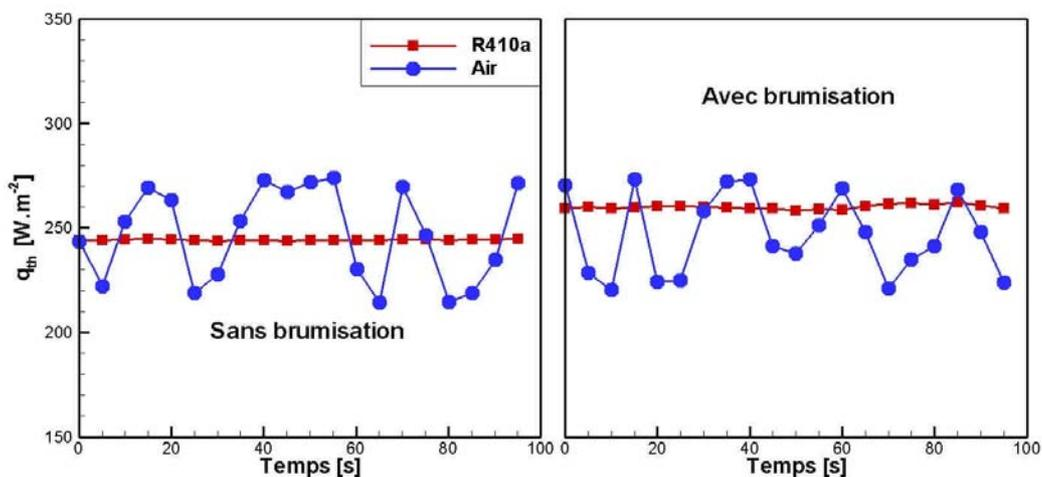
figure 6.11 - Puissances échangées au condenseur
