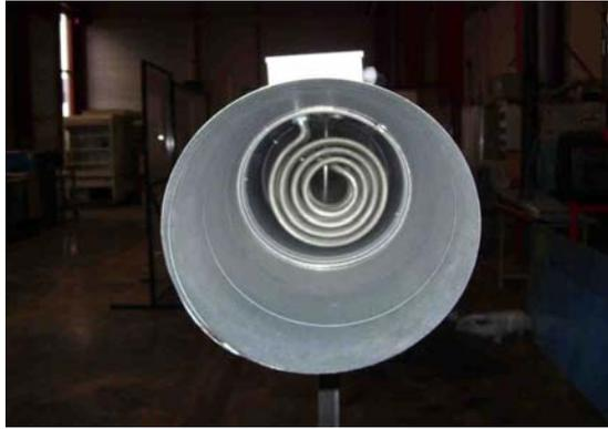
figure 4.5 - Photographie du système de chauffage de l'air
