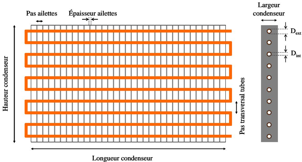
figure 3.1 - Schéma d'un échangeur à tubes ailettes
