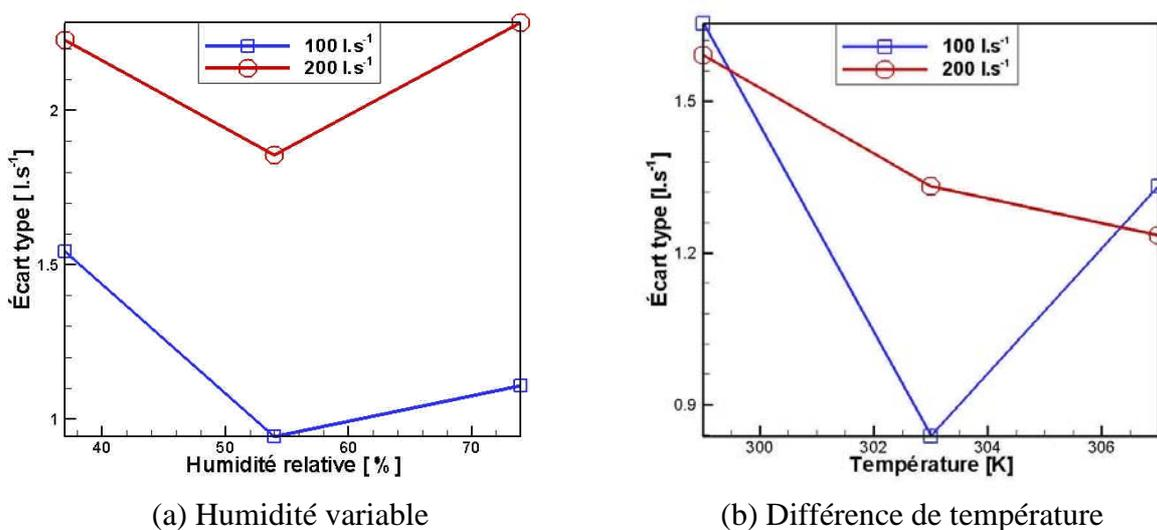
figure 4.8 - Evolution de l'écart-type du débit d'air en fonction de l'humidité (température constante) (a) et de la température de l'air ambiant (b)
