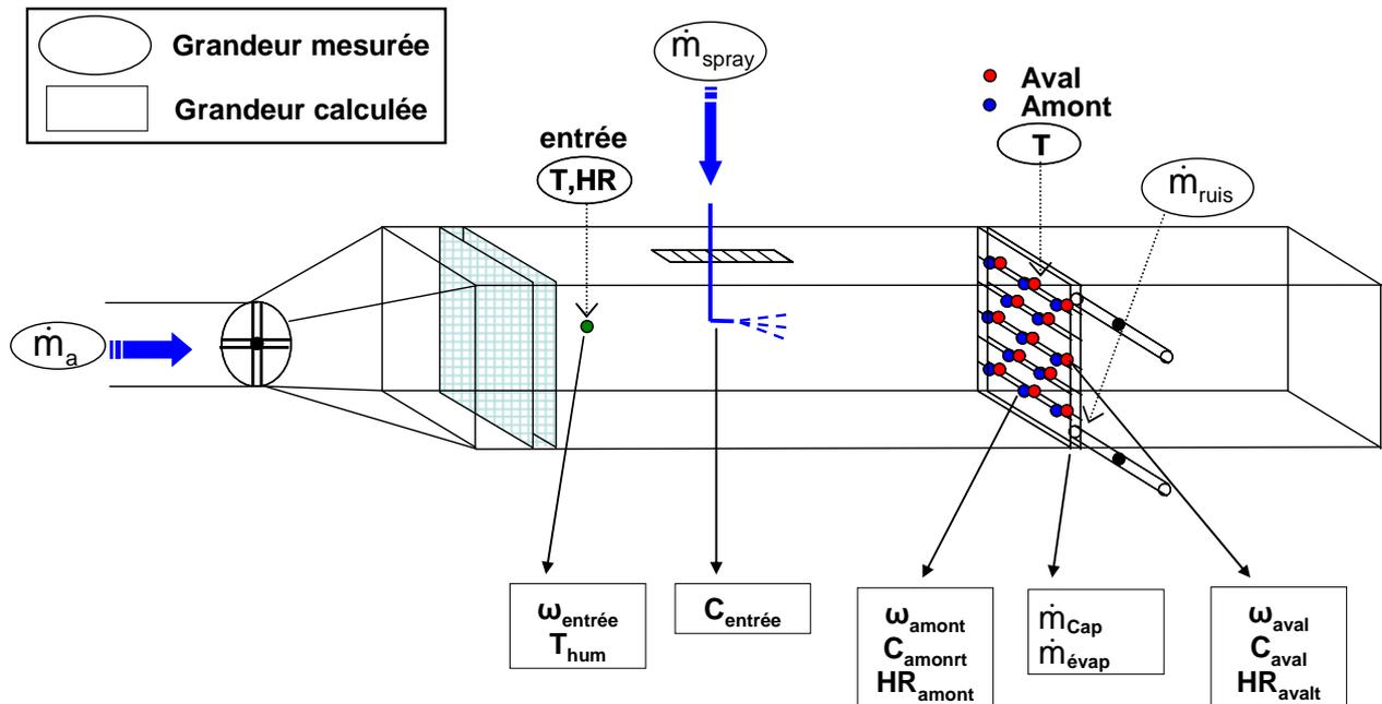
figure 4.19 - Représentation des grandeurs mesurées et calculées
