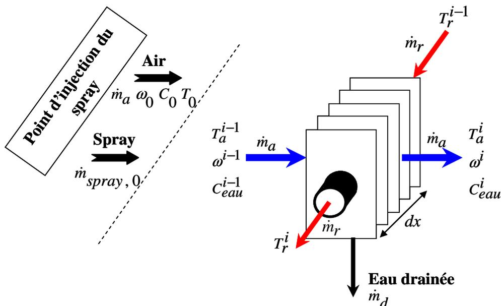
figure 3.2 - Représentation d'un élément du système étudié
