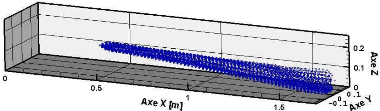
figure 2.1 - Visualisation en 3 D des trajectoires des gouttes d'eau composant le spray à co-courant
