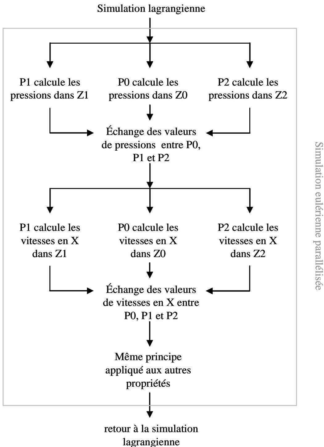
figure 1.22- Représentation schématique de la parallélisation de la simulation eulérienne
