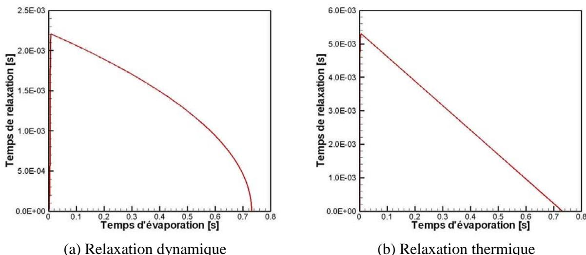
figure 1.5 - Temps de relaxation durant l'évaporation d'une goutte
