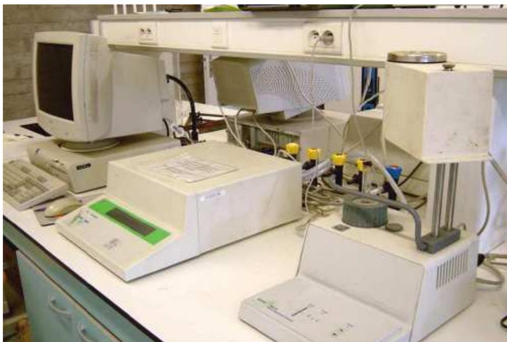
Figure 18: Appareil d'analyses thermomécaniques (TMA).
