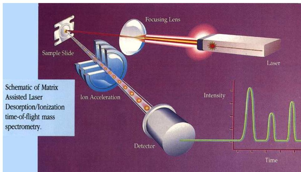
Figure 21: Principe de fonctionnement d'un appareil MALDI-ToF.
