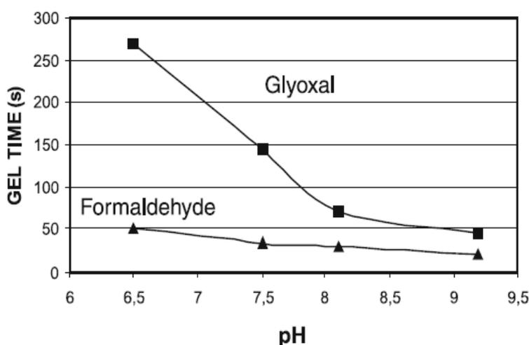
Figure 13: Temps de gel en fonction du pH de colles à base de tanin de pin radiata avec 8% de paraformaldéhyde et 9% de glyoxal. (Ballerini et al. 2005).
