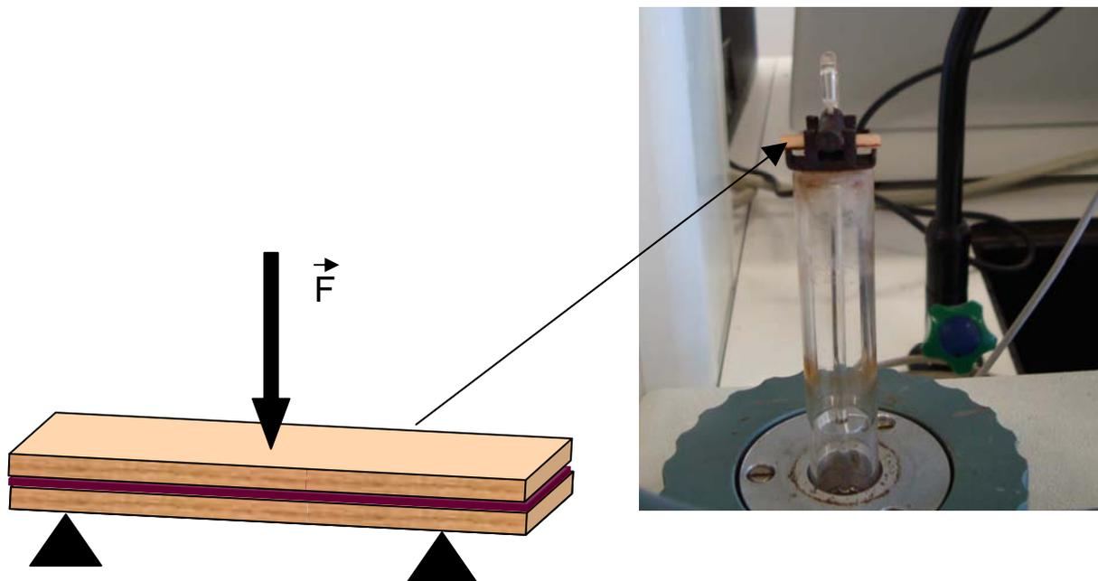
Figure 19: Analyse thermomécanique: mise en place de l'échantillon.
