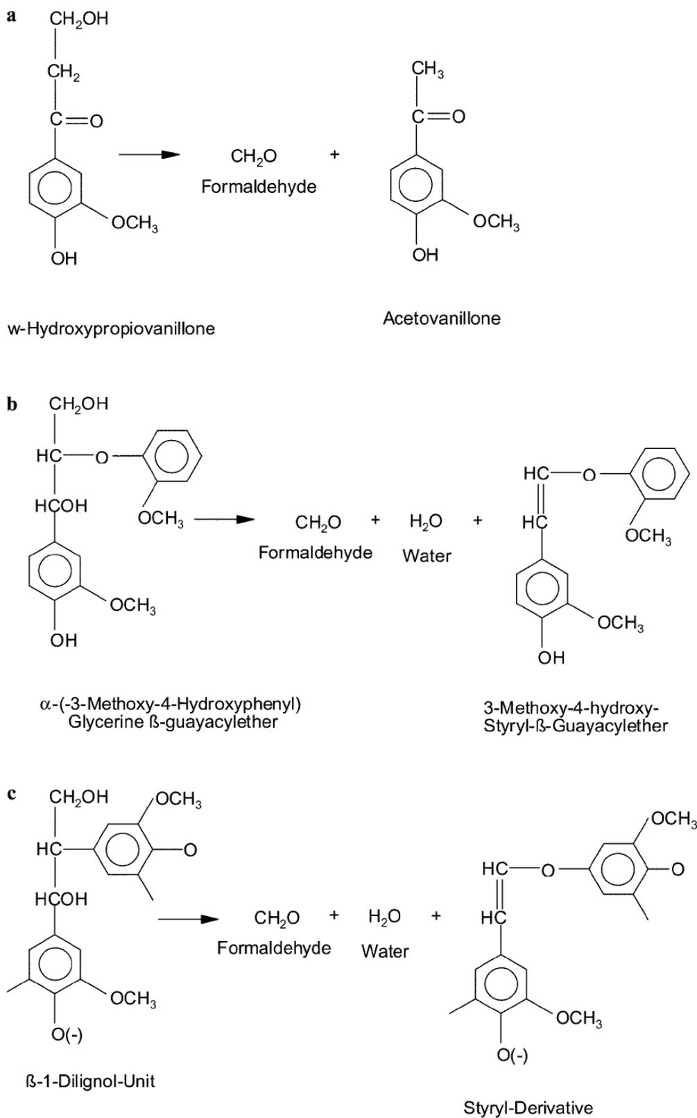
Figure 37: Voies possibles de formation de formaldéhyde à partir de la lignine.
