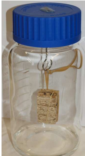
Figure 14 : Exemple de test au bocal.
