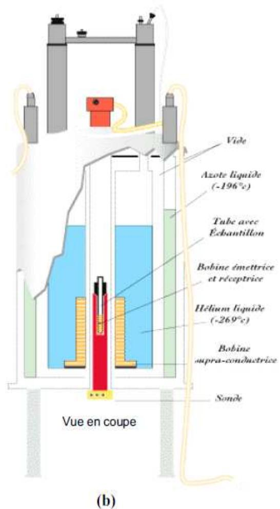
Figure 20: Appareil (a) et Schéma de RMN (b).
