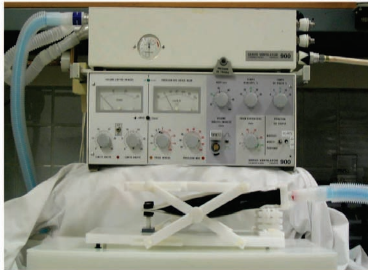
FIGURE 2.10: Photographie du respirateur et de la plateforme mobile utilisés pour simuler des mouvements périodiques.
