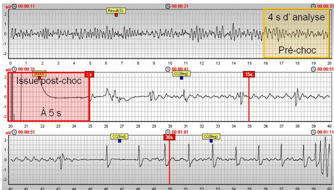
Fig. 9.1 – Principe du module de prédiction de défibrillation basé sur l'analyse de 4 s de VF immédiatement pré-choc afin de prédire l'issue de la défibrillation à 5 s post-choc.
