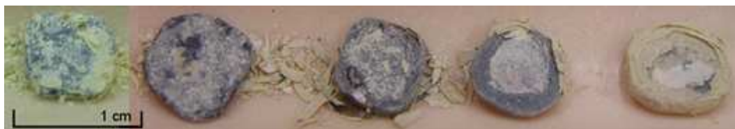
(Nb,Ti) ss HT (Nb,Ti) ss -2Sn HT (Nb,Ti) ss -4Sn HT (Nb,Ti) ss -6Sn HT (Nb,Ti) ss -8Sn HT
