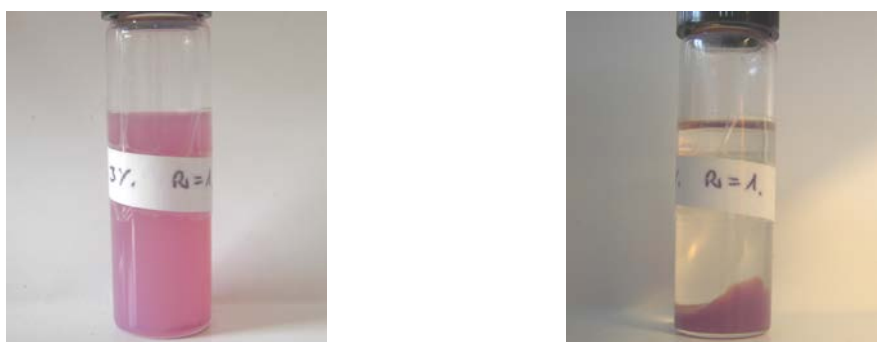
Figure IV.39 L'échantillon 2R1WE3 au moment de la synthèse (à gauche) et après plusieurs semaines (à droite). L'aspect trouble pendant la synthèse mène à long terme à un dépôt de particules.
