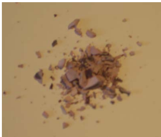
Figure IV.48 Poudre nanocristalline agglomérée (échantillon 2R9WE5).
