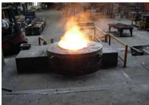
Figure 1.6 : Four à induction industriel.
