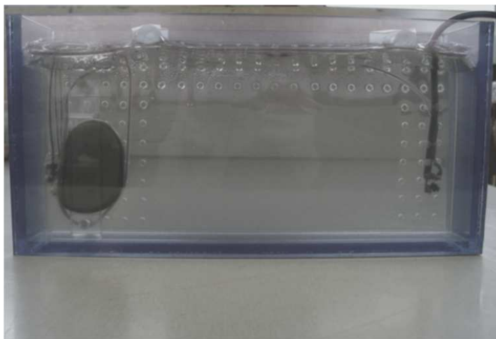
Figure 4.19 : Fantôme utilisé pour la modélisation des interférences dans le DAI.
