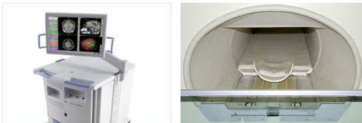
Figure 1.9: Exemples de sources électromagnétiques en environnement hospitalier : Dispositif de navigation chirurgicale par champ électromagnétique et Système d'Imagerie par Résonance Magnétique (IRM).
