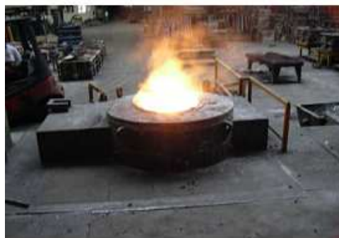
Figure 1.6 : Four à induction industriel.
