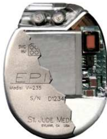
Figure 3.4 : Schéma général d'un DAI (avec l'aimable autorisation de St Jude Medical).
