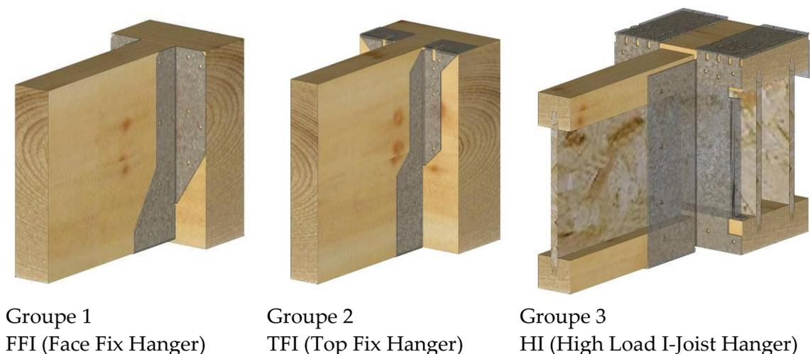
*Figure 4: Ancrages de type sabot retenu pour conduire une première étape de modélisation des ancrages de chez CULLEN BP.*
