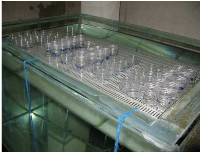
Figure 26 : Dispositif expérimental pour l'incubation individuelle des œufs de carpe
