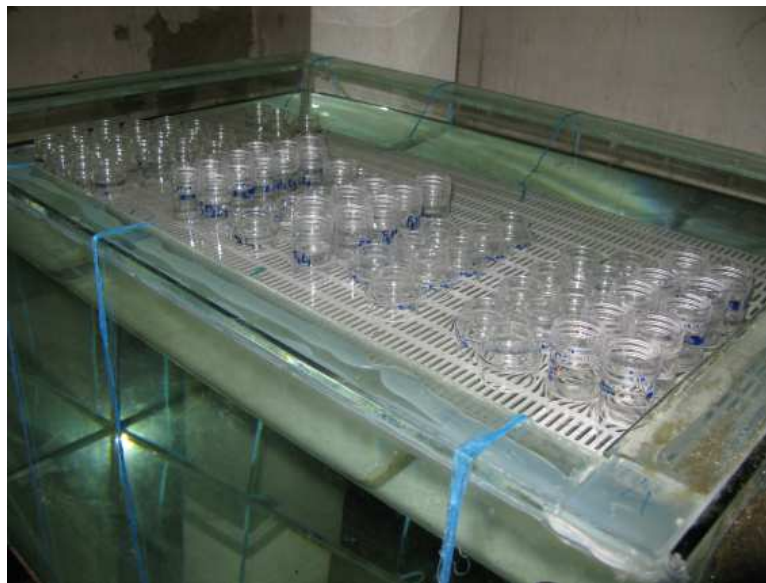
Figure 26 : Dispositif expérimental pour l'incubation individuelle des œufs de carpe
